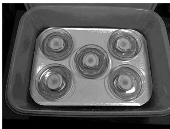
Рисунок С.3 — Герметичный контейнер для проведения испытания с чашками Петри
