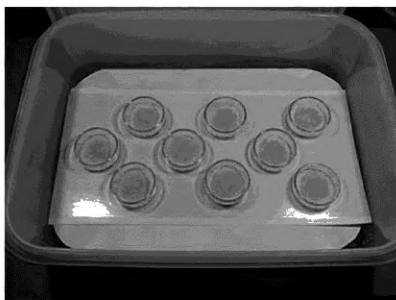
Рисунок Е.3 — Герметичный контейнер с чашками Петри для проведения испытания
