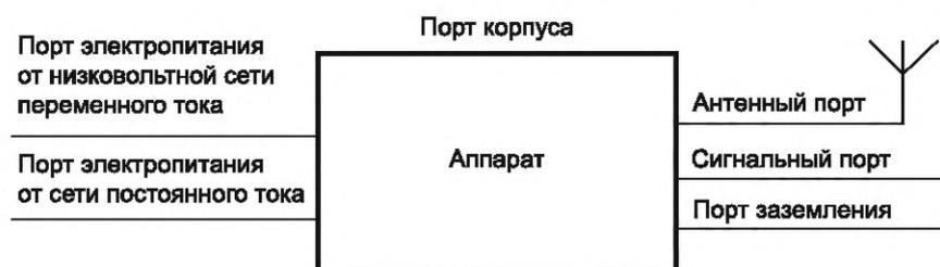
Рисунок 1 — Порты входа электромагнитных помех в устройство
