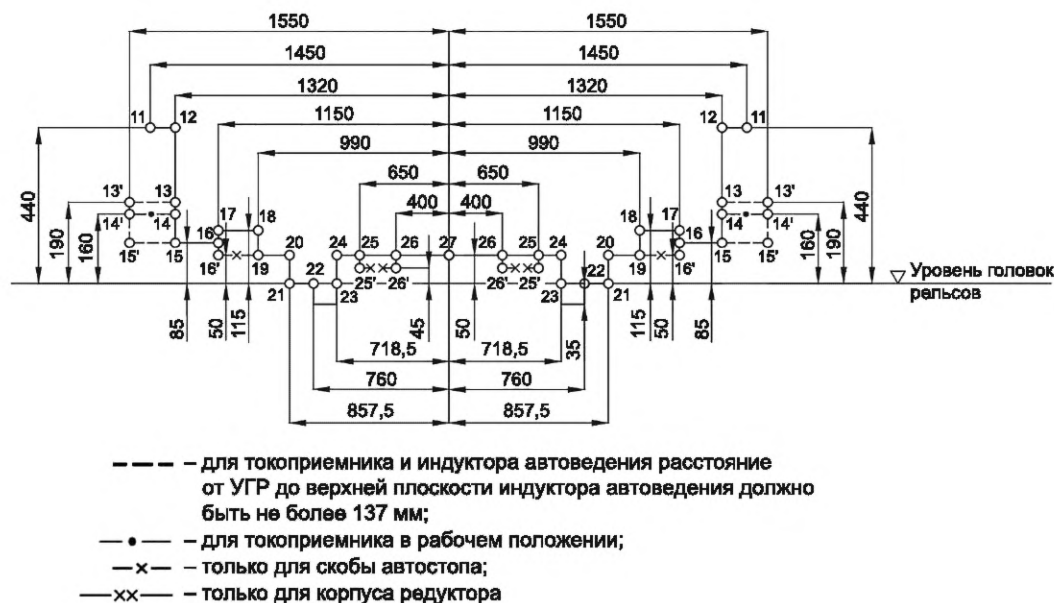
Рисунок 11 — Габарит М. Нижнее очертание габарита М
