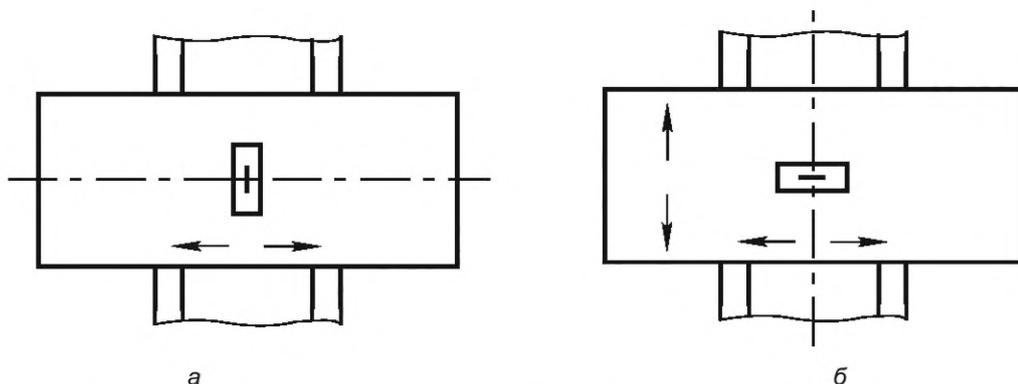
Рисунок 5 — Схема измерения углового положения рабочей поверхности стола
