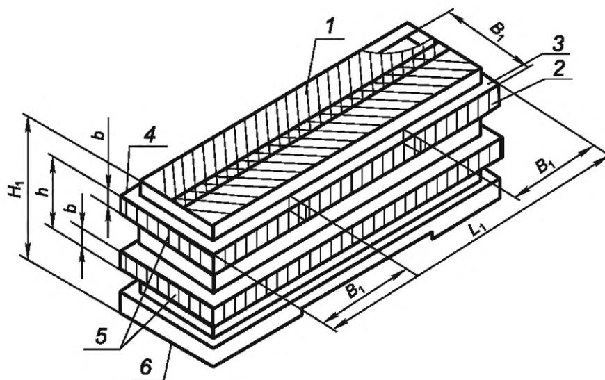
1—6 — измеряемые поверхности образца-изделия
