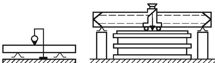
Рисунок 24 — Схема измерения прямолинейности поверхностей 1, 2 и 4
