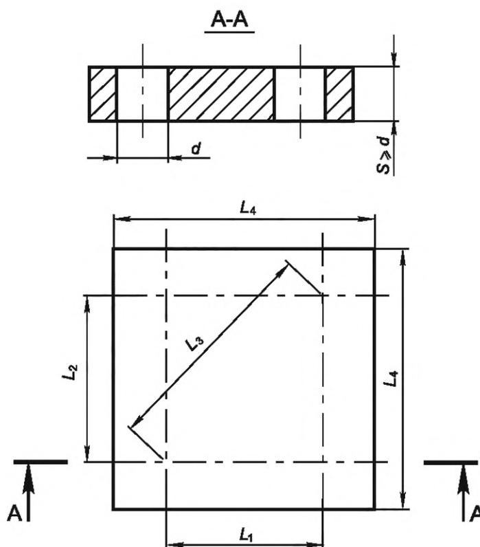
Рисунок 29 — Схема измерения точности межосевых расстояний отверстий образца-изделия
