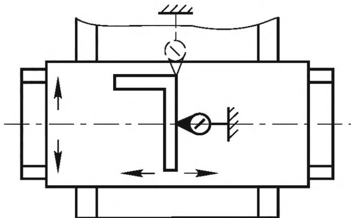
Рисунок 9 — Схема измерения перпендикулярности направления поперечного перемещения стола к направлению его продольного перемещения
