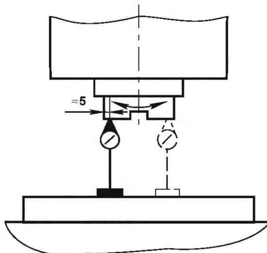
Рисунок 16 — Схема измерения торцевого биения опорного торца шпинделя
