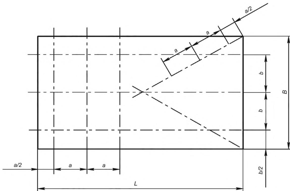
Рисунок 4 — Схема расположения сечений и точек измерения
