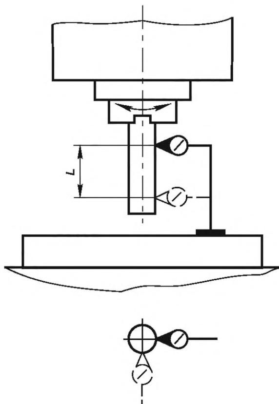
Рисунок 18 — Схема измерения радиального биения конического отверстия шпинделя
