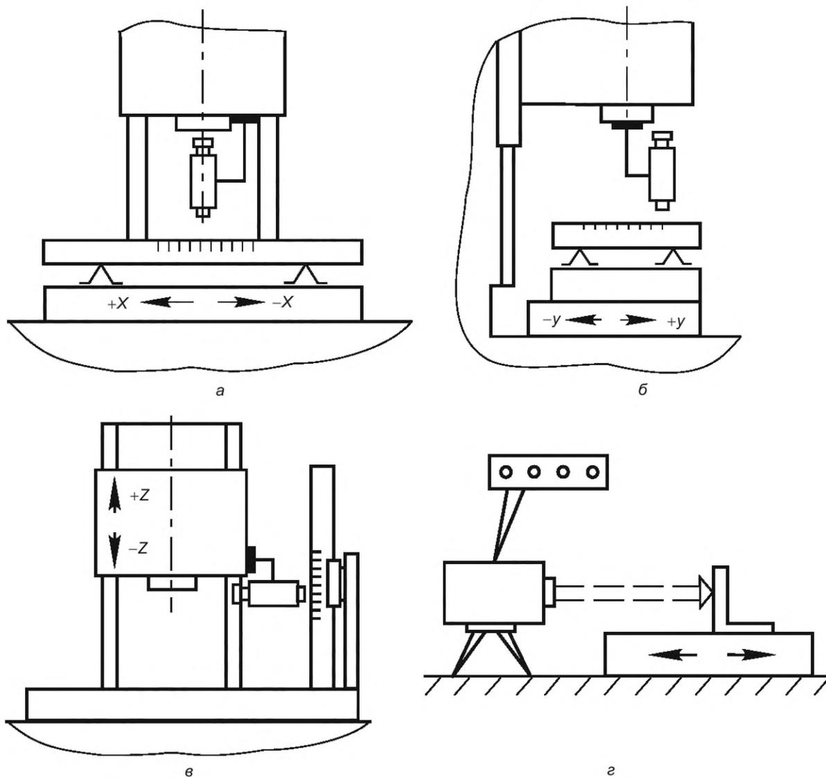
Рисунок 19 — Схема измерения точности позиционирования стола и бабки
