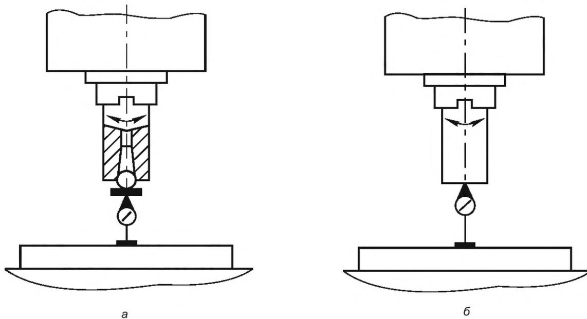
Рисунок 15 — Схема измерения осевого биения шпинделя
