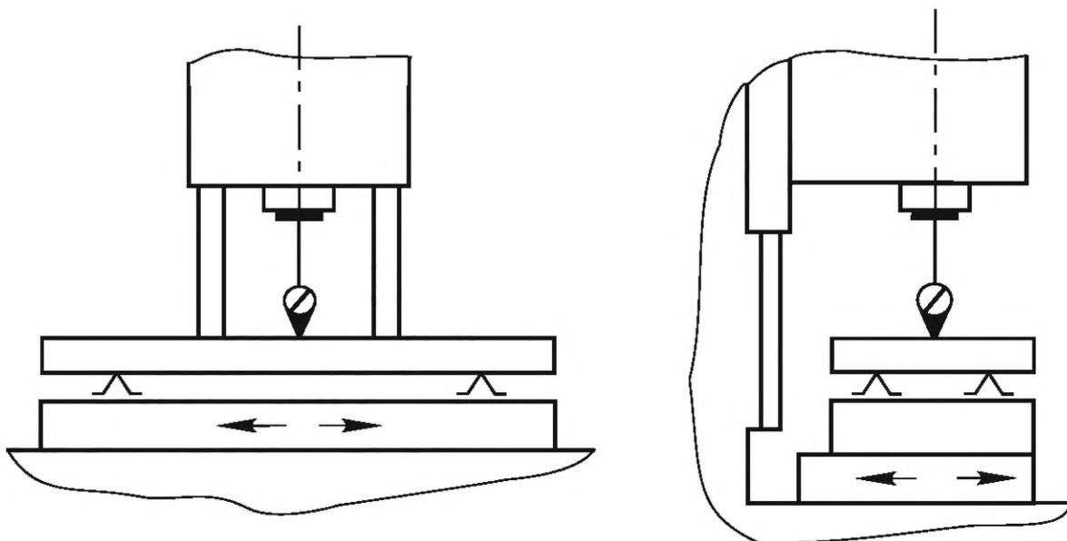
Рисунок 11 — Схема измерения прямолинейности траектории продольного и поперечного перемещений стола в вертикальной плоскости
