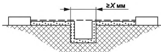
Условие: рассматриваемое расстояние утечки проходит через желобок с параллельными боковыми стенками любой глубины, шириной не менее  $X$  мм.
