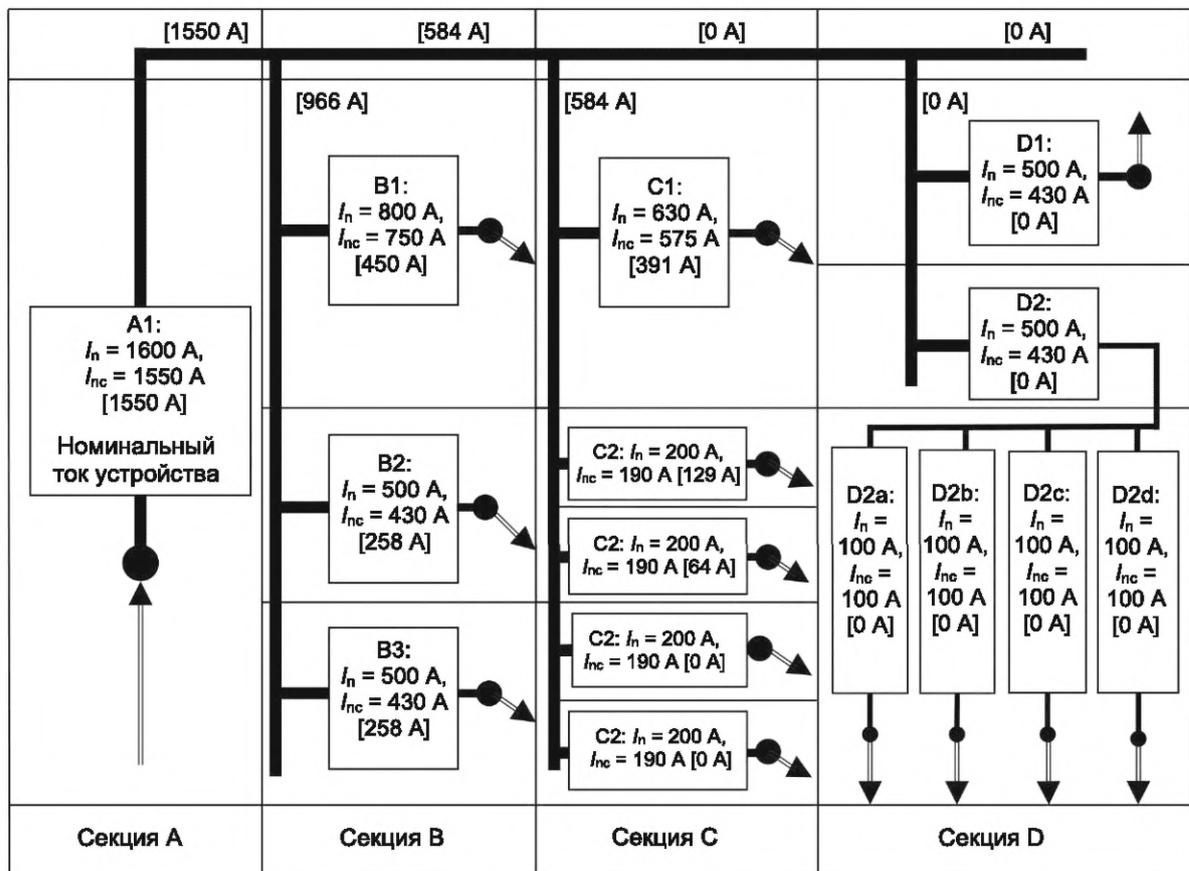
Фактическая нагрузка указана цифрами в квадратных скобках, например [450 A]. Нагрузка секции шины указана цифрами в квадратных скобках, например [584 A].
