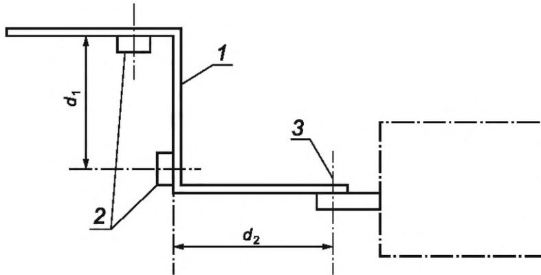
1 — шины; 2 — опоры; 3 — подключение оборудования;  $d_1$ ,  $d_2$  — размеры элементов конструкции
