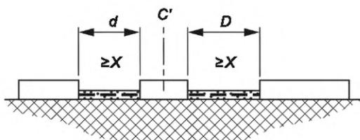
Размер воздушного зазора равен  $d + D$ . Расстояние утечки также равно  $d + D$ .  $C'$  — свободно движущаяся часть.
