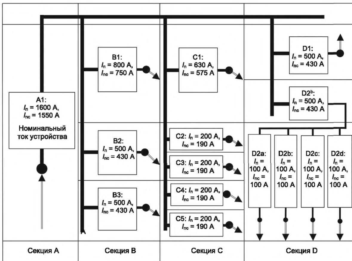
В каждом функциональном блоке (A1, B1 и т. д.) приведен номинальный ток цепи  $I_n$ <sup>a</sup>
