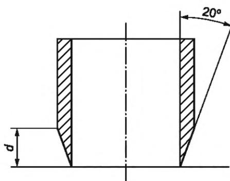
Рисунок 6 — Конструкция резачка
