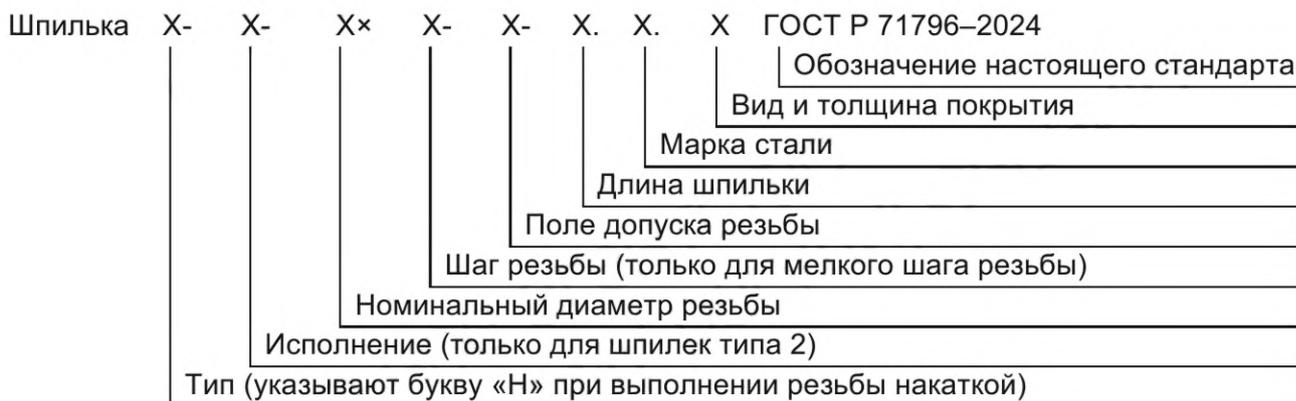
Рисунок 4 — Схема формирования условного обозначения шпилек
