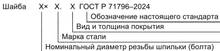
Рисунок 10 — Схема формирования условного обозначения шайб
