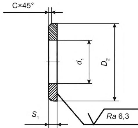
Рисунок 9 — Конструкция шайбы
