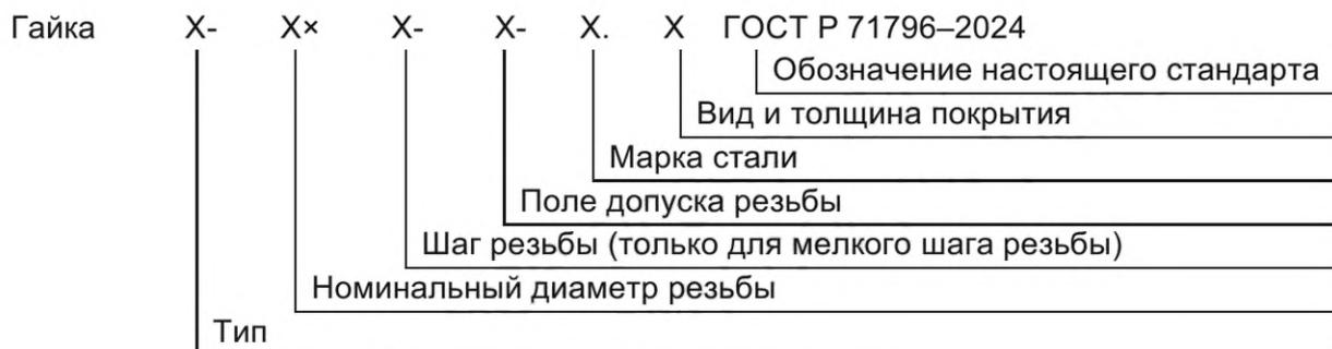
Рисунок 8 — Схема формирования условного обозначения гаек
