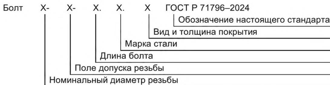
Рисунок 6 — Схема формирования условного обозначения болтов
