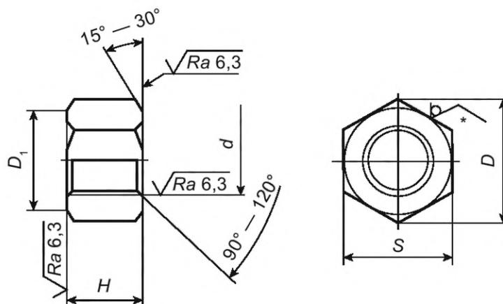
\* Шероховатость граней штампованных или кованых гаек.
