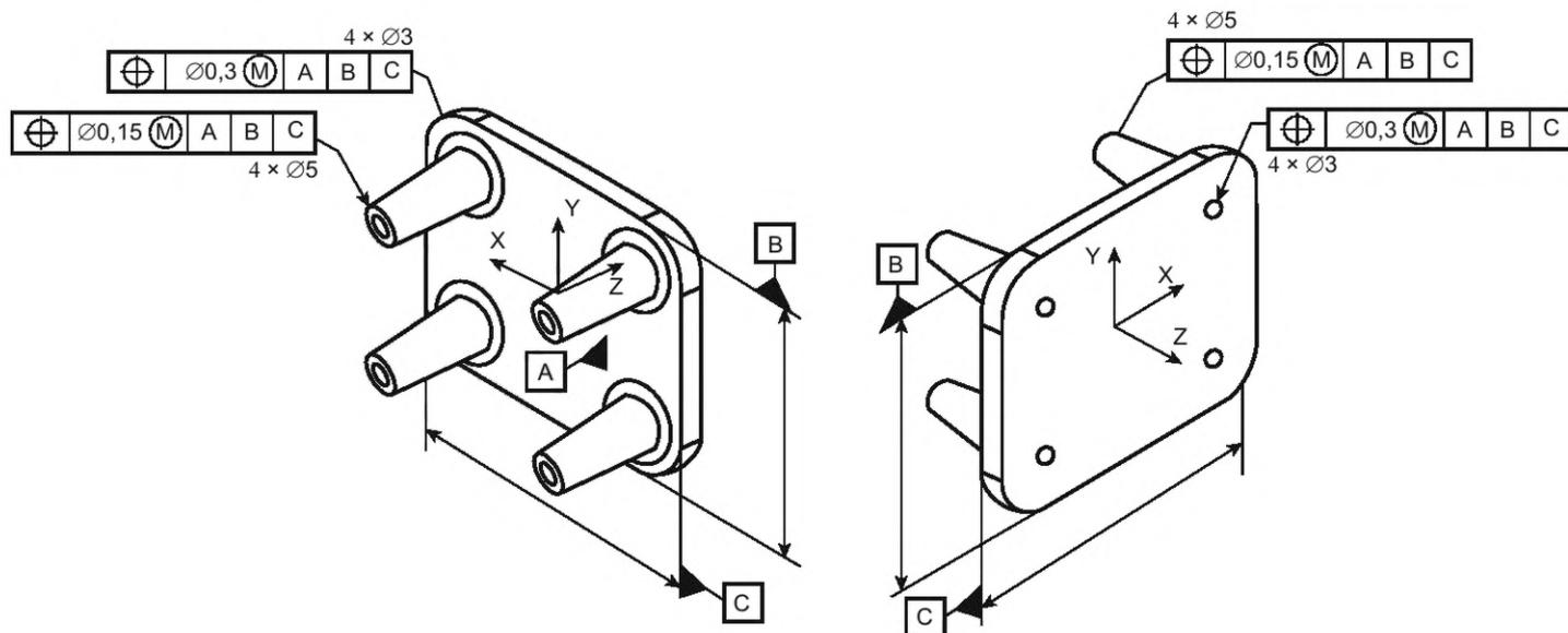
Рисунок 1 — Пример отображения аннотаций на различных видах
