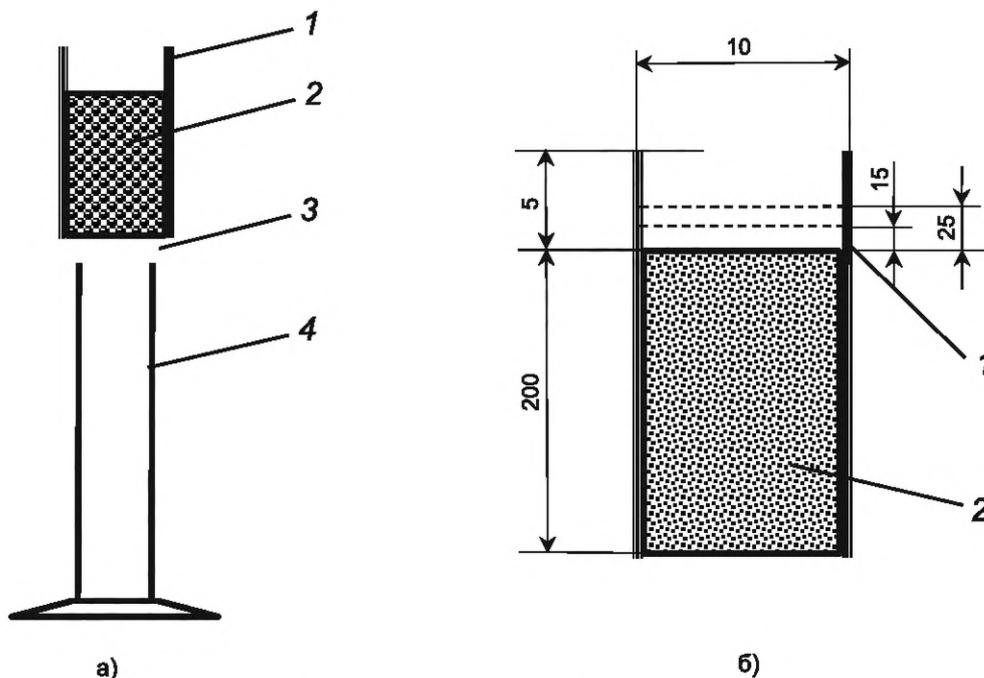
1 — образец; 2 — фильтрационная трубка; 3 — воронка; 4 — цилиндр
