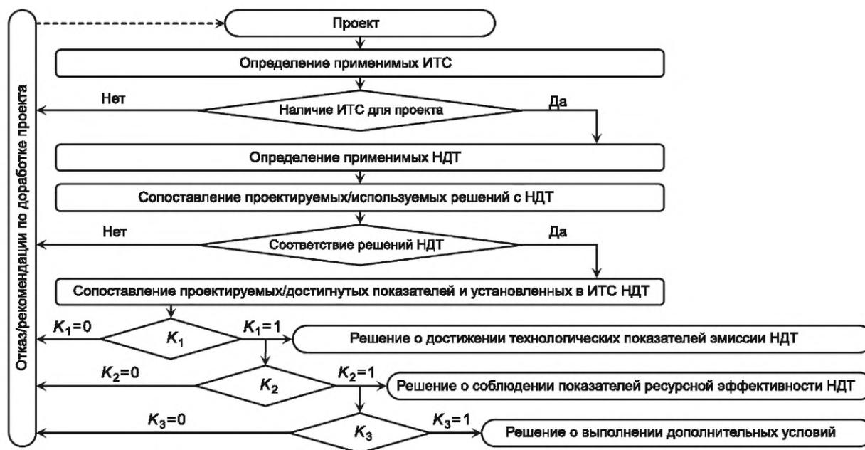
Рисунок 1 — Алгоритм экспертной оценки соответствия проектов НДТ
