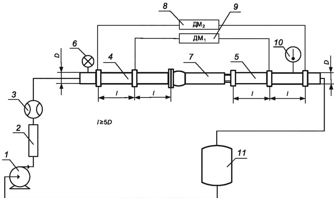
1 — насос; 2 — успокоитель потока перед измерением расхода воды; 3 — расходомер; 4 — мерная вставка; 5 — мерная вставка;
