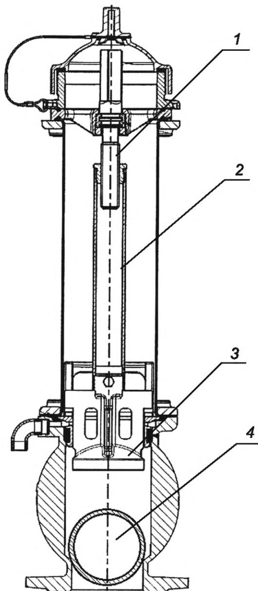
1 — шпindelь; 2 — штанга; 3 — клапан; 4 — резервный клапан
