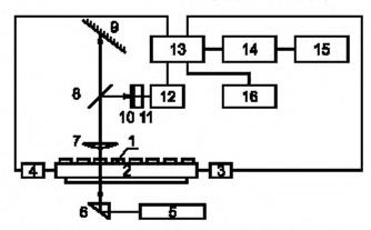
I — капилляр; 2 — каретка; 3 — привод; 4 — блок термостатирования;
