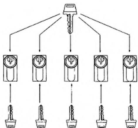
**Рисунок Б.3** — Система цилиндрических механизмов с групповым ключом — группа механизмов, каждый из которых можно открывать и закрывать как собственным ключом, так и групповым ключом, свойственным для данной группы
