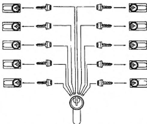
**Рисунок Б.5** — Система цилиндрических механизмов с центральным механизмом — группа цилиндрических механизмов, включающая механизм, который можно открывать и закрывать ключами, свойственными для каждого из механизмов этой группы
