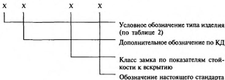
Пример условного обозначения замка врезного цилиндрического типа ЗВ1 2-го класса:
