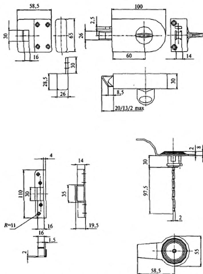
Рисунок В.17 — Пример замка накладного цилиндрического типа 3Н2 с автоматическим выводом засова-зашелки
