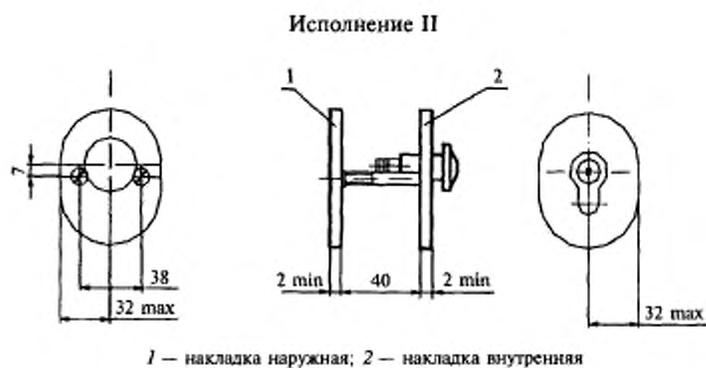
**Рисунок В.38** — Пример накладок для врезных цилиндрических замков, тип Н1
