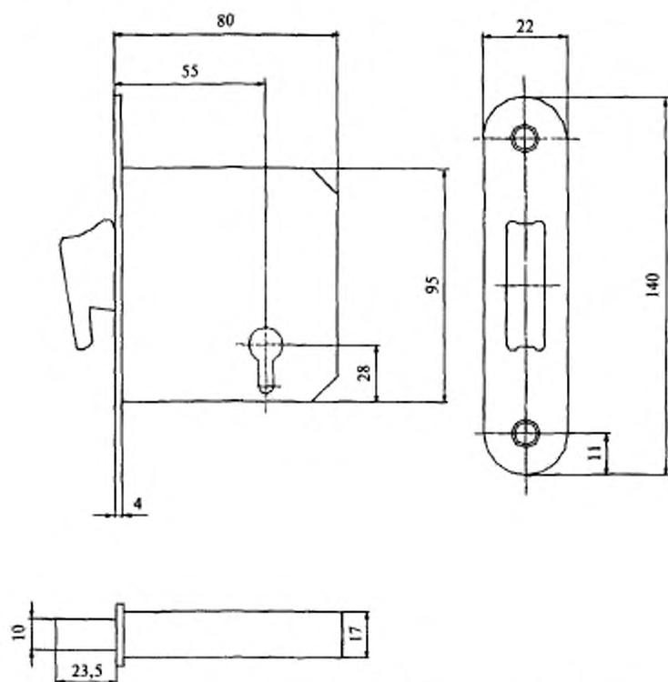
Рисунок В.2 — Пример замка врезного цилиндрического типа 3В1 с крюкообразным засовом
