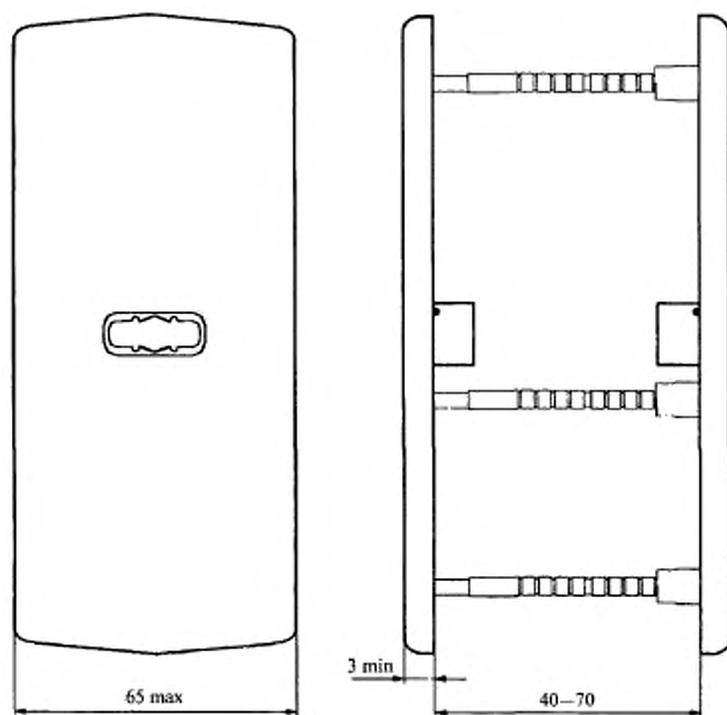
*Рисунок В.41* — Пример защитной накладки
