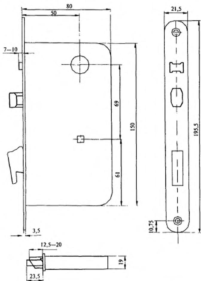
**Рисунок В.8** — Пример замка врезного цилиндрического типа ЗВ7 с крюкообразным засовом и автоматическим выводом засова-зашелки
