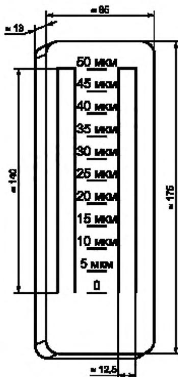
Рисунок 1 — Типовой прибор (гриндометр)
