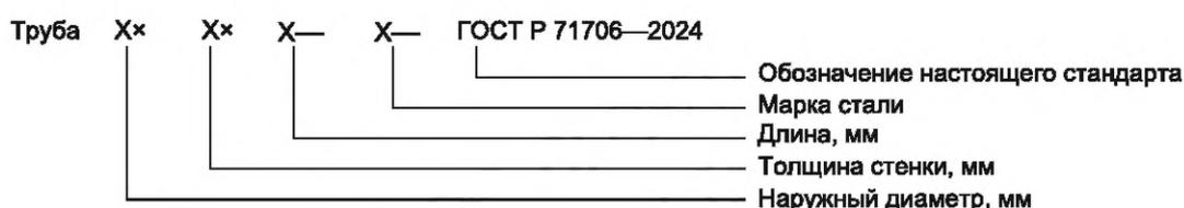
Рисунок 1 — Схема формирования условного обозначения труб
