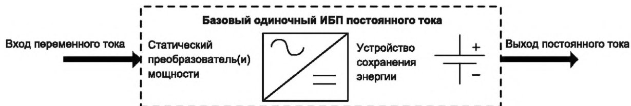
Рисунок А.1 — Базовый одиночный ИБП постоянного тока
