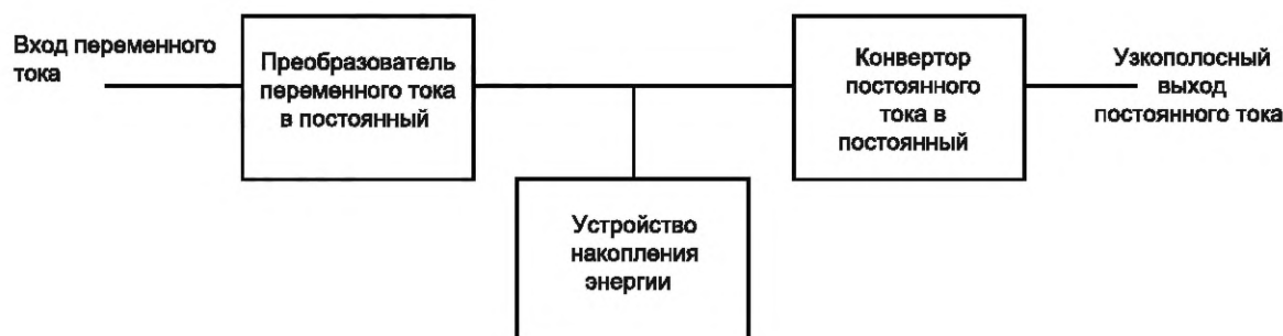
Рисунок В.2 — Топология двойного преобразования
