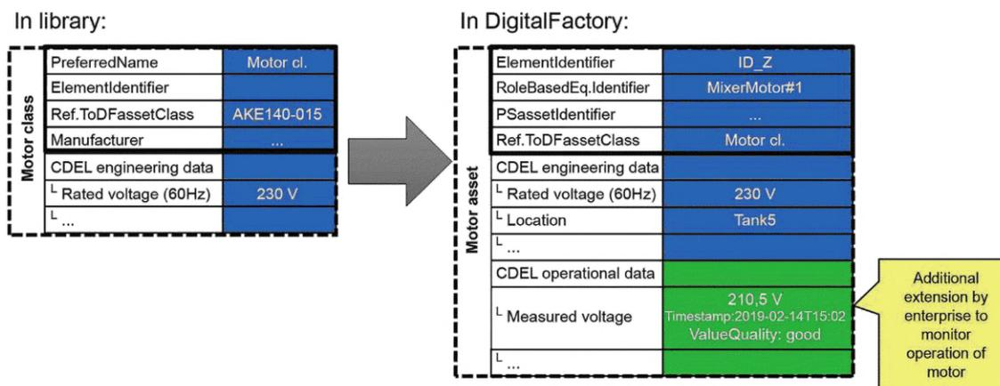
Рисунок 5 — Пример расширения актива ЦФ дополнительной информацией
