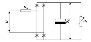
$U_{\rm C}$  — выпрямленное напряжение, В;  $R_{\rm 1}$  — резистор нагрузки с рассеиванием (выделением) активной мощности, составляющей 66 % от полной мощности S;  $R_{\rm S}$  — последовательно включенный резистор с рассеиванием (выделением) активной мощности, составляющей 4 % от полной мощности S (согласно IEC 60364-5-52 предположительная потеря напряжения в линиях сети питания составляет 4 %)
