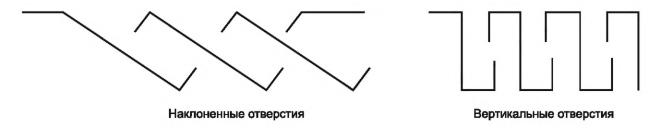
Рисунок 101 — Примеры формы конструкции с отверстиями, препятствующими вертикальному доступу
