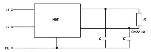
Рисунок 102— Испытательная цепь для имитации номинального напряжения, вызванного нагрузкой. Однофазный выход
