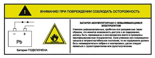
Рисунок DD.2 — Предупреждающая этикетка для продукции, транспортируемой с подключенными батареями
