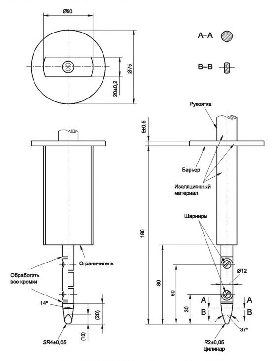
Рисунок М.101 — Испытательный шарнирный палец (IP2X)
