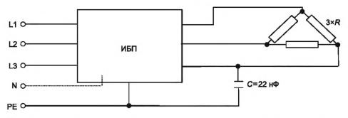
Рисунок 103— Испытательная цепь для имитации номинального напряжения потенциала, вызванного нагрузкой. Трехфазный выход
