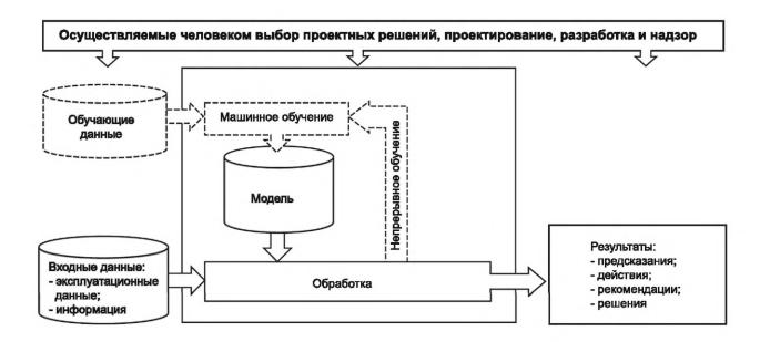
Рисунок 5 — Функциональное представление системы ИИ
