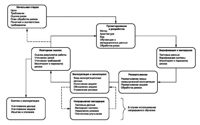
Рисунок 4 — Пример модели жизненного цикла для системы ИИ с указанием специфических для ИИ процессов
