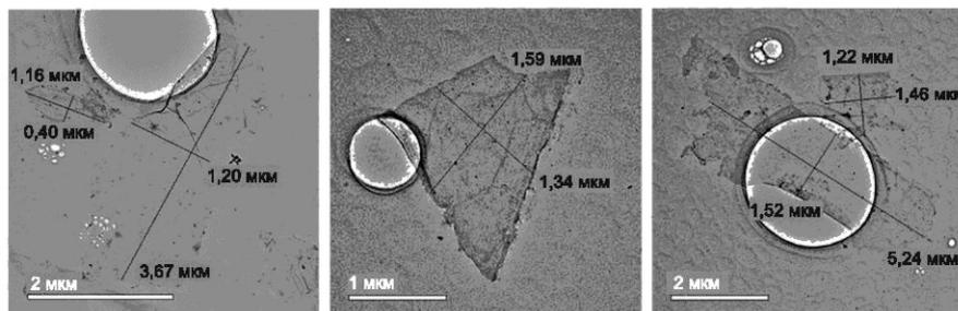
Рисунок С.5 — Светлопольные изображения ПЭМ типичных чешуек графена, полученных методом расслаивания в жидкой фазе, с указанием измеренных линейных размеров
