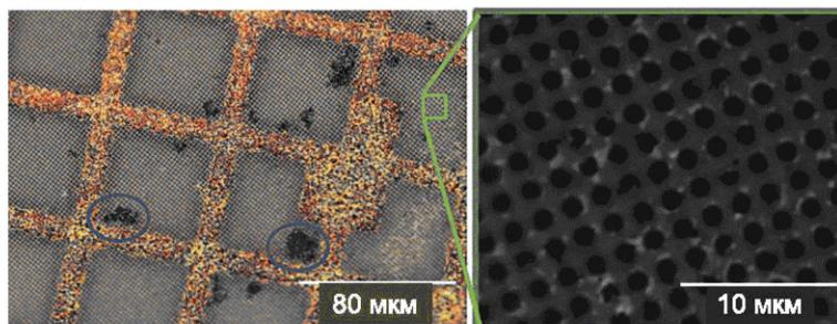
b) Изображение чешуек графена, расположенных на сетке ПЭМ близко друг к другу (то есть образец наноматериала не пригоден для измерений)
