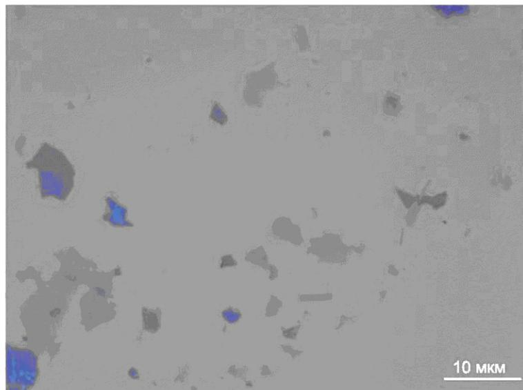
**Примечание** — Нанесение токопроводящего слоя (как правило, золота) на поверхность непроводящего образца перед измерением методом РЭМ является необходимым условием. Однако вследствие небольших размеров измеряемых объектов такое нанесение может осложнить оценку размеров чешуек графена из-за нанесения слоя проводящего материала аналогичной или большей толщины. Таким образом, не рекомендуется наносить токопроводящий слой на образец.
