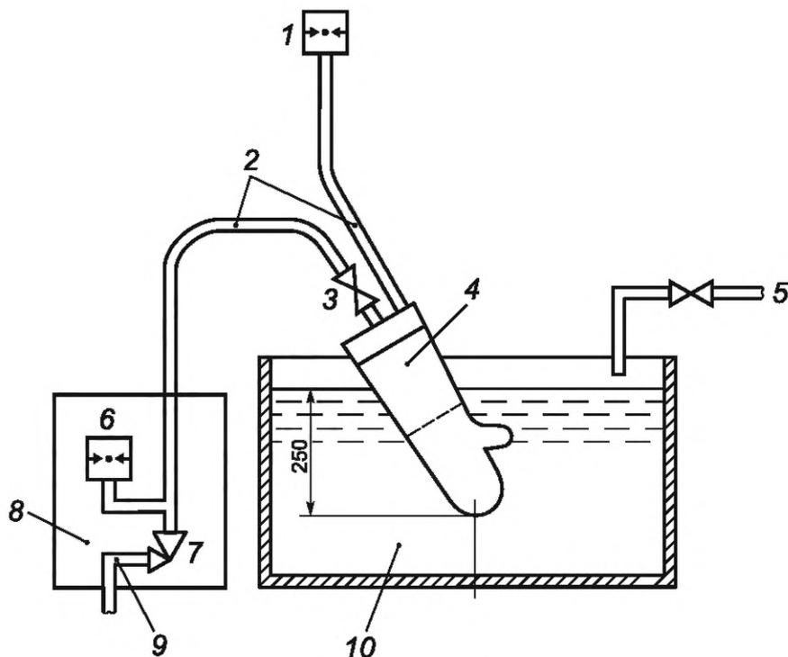
1 — манометр; 2 — гибкие трубки; 3 — обратный клапан; 4 — коническая насадка для крепления перчатки; 5 — подача воды; 6 — манометр; 7 — регулятор давления; 8 — панель управления; 9 — подача сжатого воздуха; 10 — емкость
