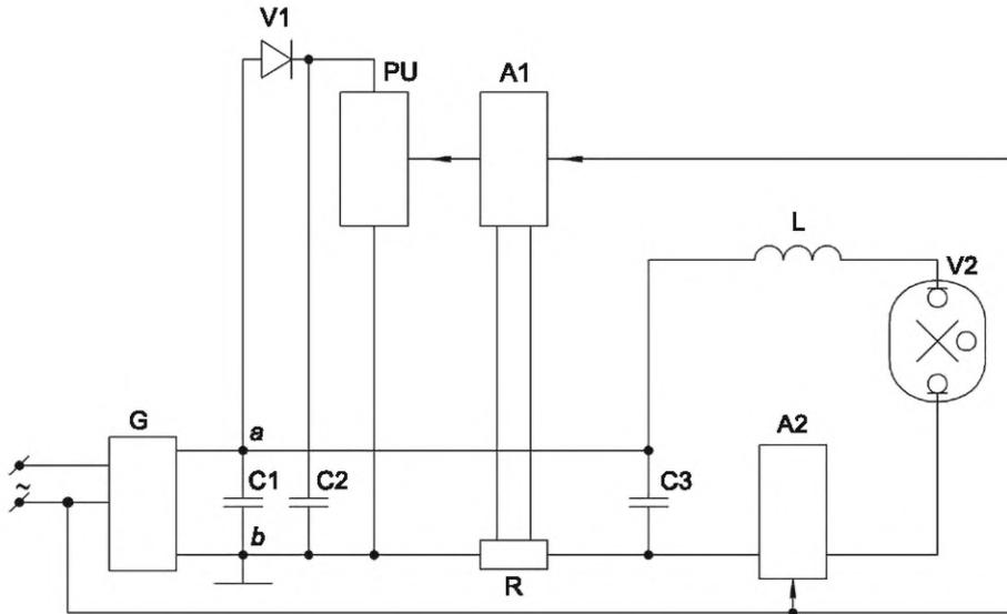
C1, C2, C3 — конденсаторы; V2 — импульсная лампа; V1 — диод; G — регулируемый источник постоянного тока; PU — аналоговый или цифровой вольтметр; A1 — формирователь сигнала запуска для цифрового вольтметра; A2 — зажигающее устройство; R — шунт
