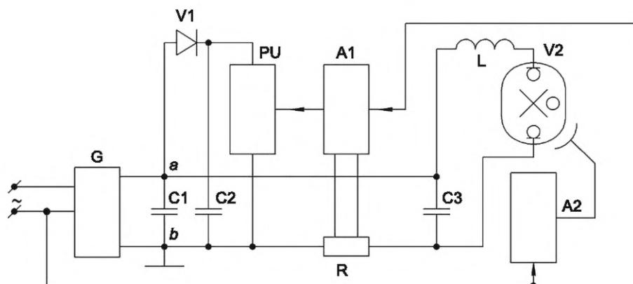
С1, С2, С3 — конденсаторы; V2 — импульсная лампа; V1 — диод; G — регулируемый источник постоянного тока; PU — аналоговый или цифровой вольтметр; A1 — формирователь сигнала запуска для цифрового вольтметра; A2 — зажигающее устройство; R — шунт
