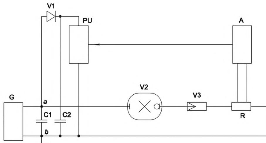
C1, C2, C3 — конденсаторы; V1 — диод; V2 — импульсная лампа; G — регулируемый источник постоянного тока; PU — аналоговый или цифровой вольтметр; V3 — разрядник; A — формирователь сигнала запуска для цифрового вольтметра; R — шунт
