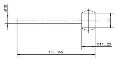
б) Молоточек с цилиндрическим бойком
