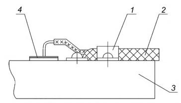
Рисунок А.2 — Конструкция пьезоэлектрического преобразователя
