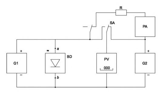
G1 — источник тока считывания; BD — детектор; SA — переключатель; PV — вольтметр; R — резистор; PA — амперметр; G2 — источник напряжения; *a, b* — точки подключения детектора
