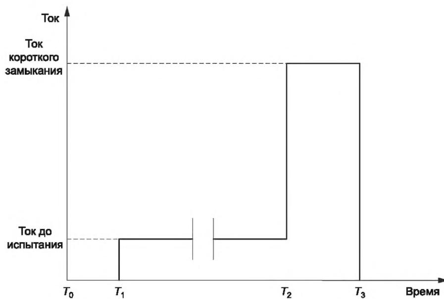
$T_0$  — размыкание короткозамыкающего переключателя (см. 9.3.4.1.6 а));  $T_1$  — испытательная цепь под напряжением (см. 9.3.4.1.6 б));  $T_2$  — замыкание короткозамыкающего переключателя (9.3.4.1.6 с));  $T_3$  — УЗКЗ отключает короткое замыкание
