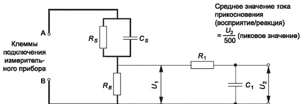
$$R_S = 1\,500 \text{ Ом}; R_B = 500 \text{ Ом}; R_1 = 10 \text{ кОм}; C_S = 0,22 \text{ мкФ}; C_1 = 0,022 \text{ мкФ}$$
