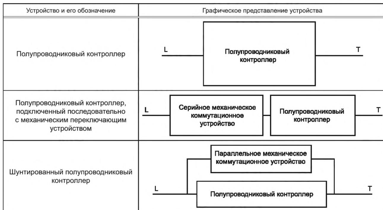
Рисунок 1 — Полупроводниковые устройства управления
