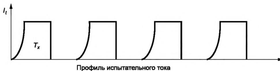
Рисунок F.1 — Профиль испытания на тепловую стабильность
