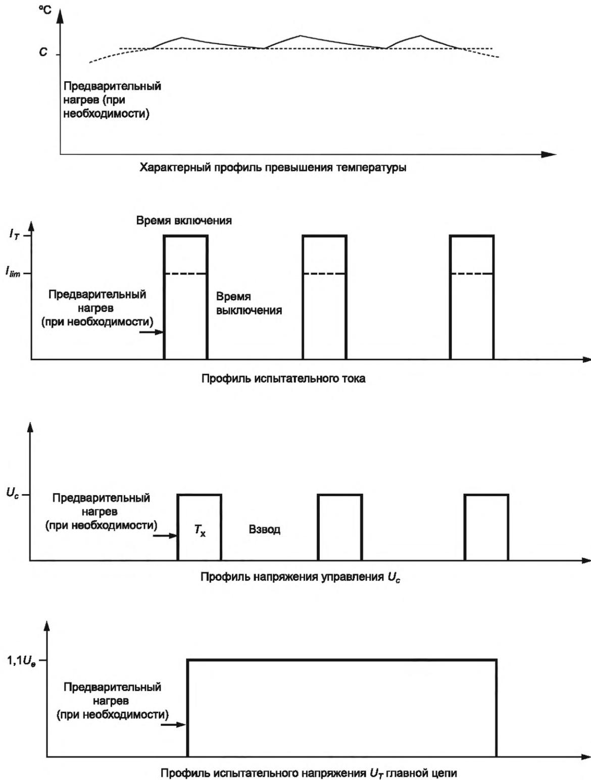
Рисунок F.2 — Профиль испытания на перегрузочную способность
