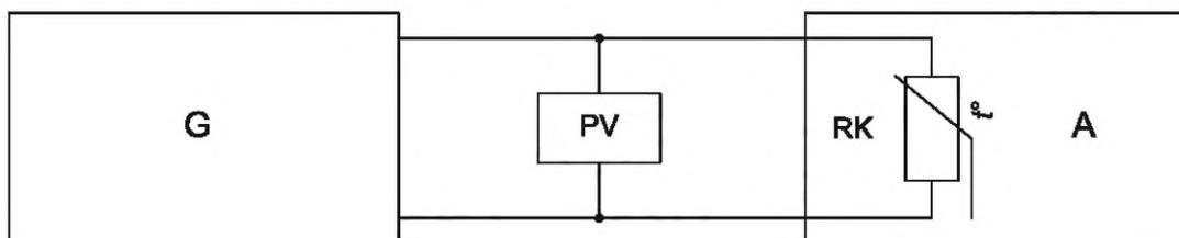
G — источник постоянного тока с регулируемым выходом; PV — цифровой вольтметр; RK — термистор; A — термостатирующая камера
