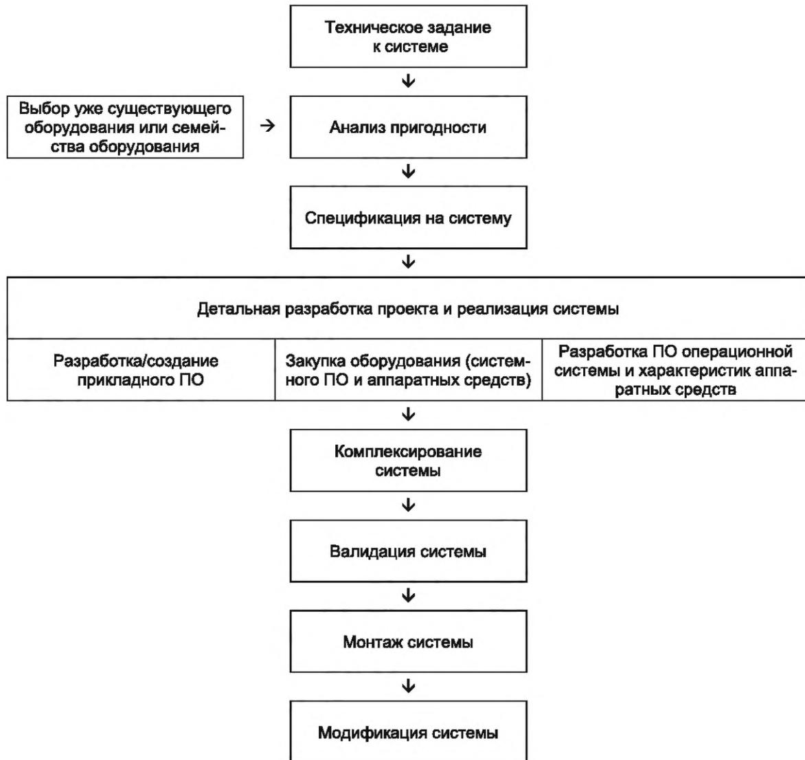
Рисунок 1 — Жизненный цикл безопасности системы
