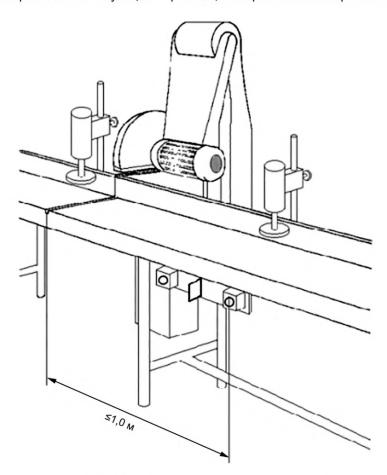
Рисунок 2 — Расположение двуручного устройства управления на полуавтоматических станках
