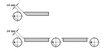
Рисунок 6 — Пример защиты роликового конвейера
