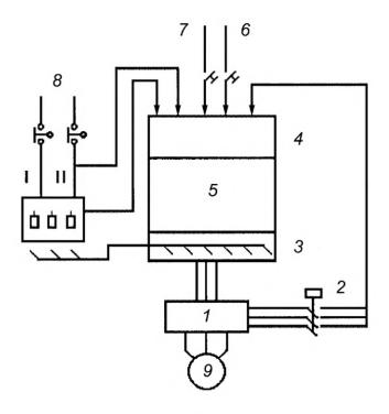
1 — контроллер привода; 2 — контактор; 3 — выход программируемой электронной системы; 4 — вход программируемой электронной системы; 5 — программируемая электронная система; 6 — останов; 7 — пуск; 8 — блокируемое ограждение; 9 — двигатель
