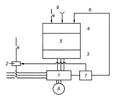
1— контроллер привода; 2— контактор для двигателя; 3— выход программируемой электронной системы; 4— вход программируемой электронной системы; 5— программируемая электронная система; 6— цепь тестирования; 7— управляющая программа; 8— двигатель; 9— орган управления пуском и остановом
