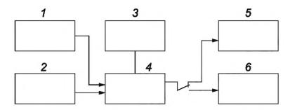
1 — осветитель и оптическая система фоновой засветки фотокатода; 2 — осветитель и оптическая система с устройством перемещения световой точки; 3 — генератор разверток; 4 — диссектор; 5 — осциллограф выделения строки; 6 — измеритель постоянного тока
