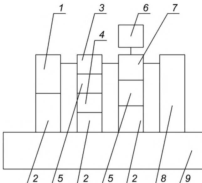
1 — лазер или излучатель; 2 — направляющая; 3 — набор ослабителей мощности (энергии) лазерного излучения; 4 — держатель фильтров; 5 — рейтер; 6 — источник питания приемника излучения; 7 — приемник излучения; 8 — частотомер; 9 — рельс оптической скамьи
