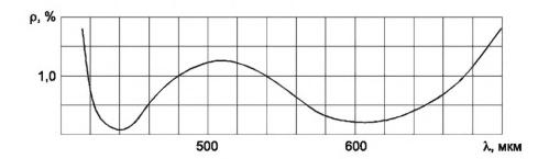
Рисунок Е.3 — Кривая спектрального коэффициента отражения  $\rho(\lambda)$  двухслойного ахроматического покрытия 44Р.43Р на стекле марки TK21
