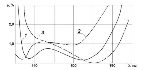
1 — без ошибок в оптической толщине 3-го слоя  $(n_1h_1=n_3h_3=125$  нм,  $n_2h_2=250$  нм); 2 — с ошибкой минус 20 нм в оптической толщине 3-го слоя; 3 — с ошибкой плюс 20 нм в оптической толщине 3-го слоя
