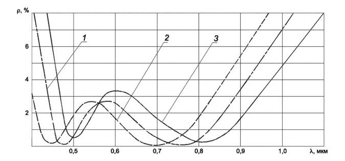
1 — без ошибок в оптических толщинах слоев ( $n_1h_1$  = 0,32 мкм,  $n_2h_2$  = 0,15 мкм); 2 — с ошибкой в оптических толщинах слоев ( $n_1h_1$  = 0,32 мкм,  $n_2h_2$  = 0,13 мкм); 3 — с ошибкой в оптических толщинах слоев ( $n_1h_1$  = 0,32 мкм,  $n_2h_2$  = 0,17 мкм)
