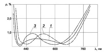
1 — без ошибок в оптической толщине 1-го слоя ( $n_1h_1=n_3h_3=125$  нм,  $n_2h_2=250$  нм); 2 — с ошибкой минус 20 нм в оптической толщине 1-го слоя; 3 — с ошибкой плюс 20 нм в оптической толщине 1-го слоя
