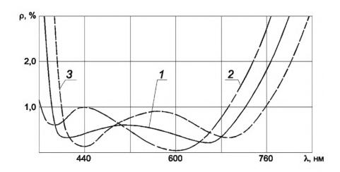
1 — без ошибок в оптической толщине 2-го слоя  $(n_1h_1=n_3h_3=125~{\rm Hm},~n_2h_2=250~{\rm Hm});$  2 — с ошибкой минус 20 нм в оптической толщине 2-го слоя; 3 — с ошибкой плюс 20 нм в оптической толщине 2-го слоя
