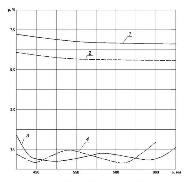
1 — детали из стекол марки БФ16 без покрытия; 2 — детали из стекол марки ТК16 без покрытия; 3 — детали из стекол марки ТК16 с покрытием 43/51P.46P.43P.350; 4 — детали из стекол марки БФ16 с покрытием 45P.46P.43P350
