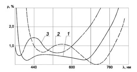
1 — без ошибок в оптических толщинах слоев ( $n_1h_1=n_3h_3=125$  нм,  $n_2h_2=250$  нм); 2, 3 — с разнозначными ошибками ( $\pm 20$  нм) в оптической толщине 1-го и 3-го слоев
