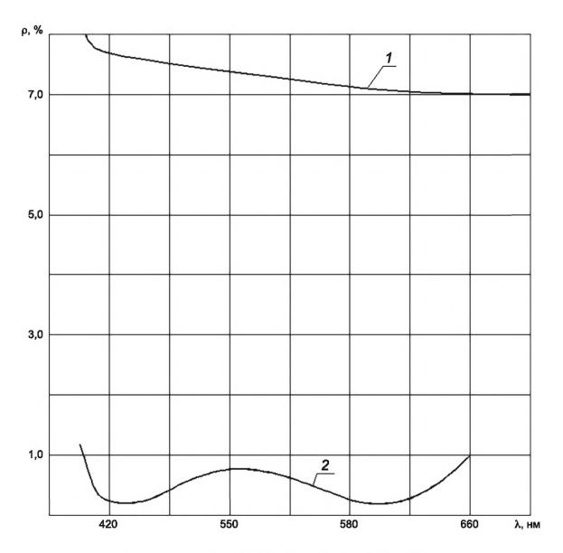
1 — детали из стекол марки ТФ7 с покрытием 200.45Р.46Р.43Р.280; 2 — детали из стекол марки ТФ7 без покрытия
