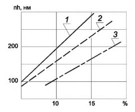
1 — частота вращения детали составляет 1000 мин $^{-1}$ ; 2 — частота вращения детали составляет 2500 мин $^{-1}$ ; 3 — частота вращения детали составляет 4800 мин $^{-1}$
