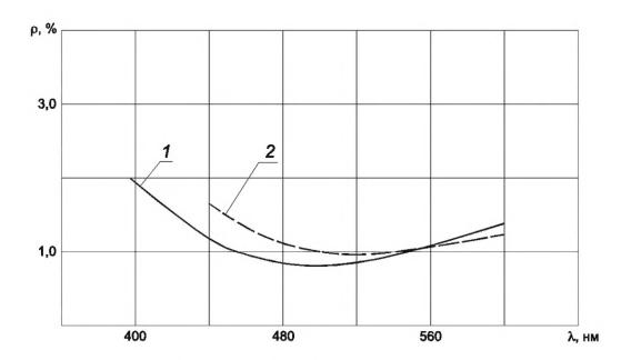
1 — образцы из стекла марки ТФ7 [ $\lambda(\rho_{\min})$  = 500 нм,  $n_3h_3$  = 125 нм]; 2 — образцы из стекла марки ТФ7 [ $\lambda(\rho_{\min})$  = 520 нм,  $n_3h_3$  = 130 нм]
