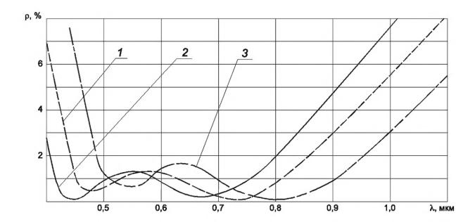
1 — без ошибок в оптических толщинах слоев ( $n_1h_1=0,28$  мкм,  $n_2h_2=0,15$  мкм); 2 — с ошибкой в оптических толщинах слоев ( $n_1h_1=0,28$  мкм,  $n_2h_2=0,13$  мкм); 3 — с ошибкой в оптических толщинах слоев ( $n_1h_1=0,28$  мкм,  $n_2h_2=0,17$  мкм)
