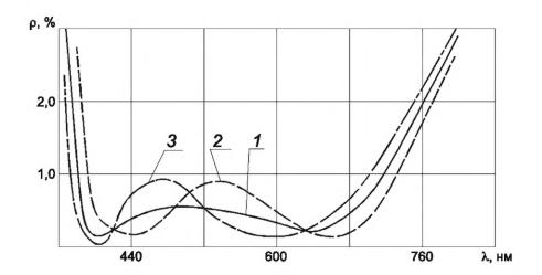
1 — без ошибок в оптической толщине слоев ( $n_1h_1=n_3h_3=125$  нм,  $n_2h_2=250$  нм); 2, 3 — с разнозначными ошибками ( $\pm 20$  нм) в оптических толщинах 1-го и 2-го слоев
