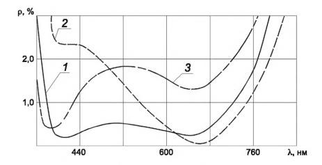
1 — без ошибок в оптических толщинах слоев ( $n_1h_1=n_3h_3=125$  нм,  $n_2h_2=250$  нм); 2, 3 — с разнозначными ошибками ( $\pm 20$  нм) в оптической толщине 2-го и 3-го слоев
