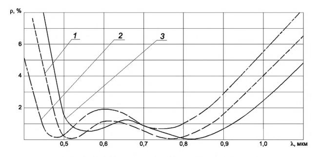
1 — без ошибок в оптических толщинах слоев ( $n_1h_1$  = 0,32 мкм,  $n_2h_2$  = 0,15 мкм); 2 — с ошибкой в оптических толщинах слоев ( $n_1h_1$  = 0,32 мкм,  $n_2h_2$  = 0,13 мкм); 3 — с ошибкой в оптических толщинах слоев ( $n_1h_1$  = 0,32 мкм,  $n_2h_2$  = 0,17 мкм)
