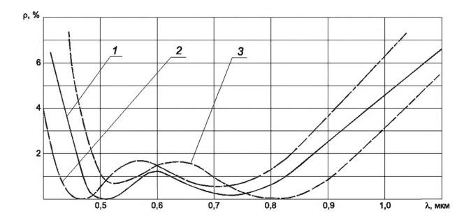
1 — без ошибок в оптических толщинах слоев (  $n_1h_1$  = 0,3 мкм,  $n_2h_2$  = 0,15 мкм); 2 — с ошибкой в оптических толщинах слоев (  $n_1h_1$  = 0,3 мкм,  $n_2h_2$  = 0,13 мкм); 3 — с ошибкой в оптических толщинах слоев (  $n_1h_1$  = 0,3 мкм,  $n_2h_2$  = 0,17 мкм)
