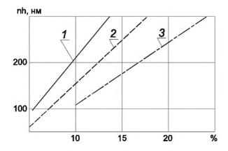
1 — частота вращения детали составляет 1000 мин $^{-1}$ ; 2 — частота вращения детали составляет 2500 мин $^{-1}$ ; 3 — частота вращения детали составляет 4800 мин $^{-1}$
