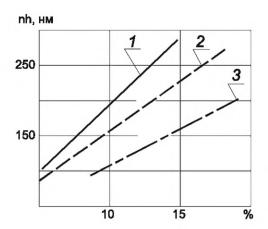
1 — частота вращения детали составляет 1000 мин $^{-1}$ ; 2 — частота вращения детали составляет 2500 мин $^{-1}$ ; 3 — частота вращения детали составляет 4800 мин $^{-1}$
