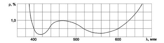
Рисунок Е.6 — Кривая спектрального коэффициента отражения  $\rho(\lambda)$  двухслойного ахроматического покрытия 44P.43P на стекле марки ТФ10
