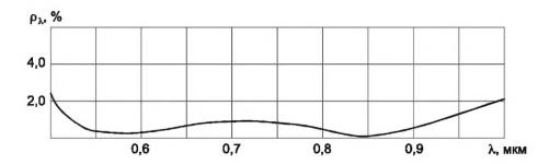
Рисунок Е.10 — Кривая спектрального коэффициента отражения  $\rho(\lambda)$  от поверхности детали из стекла марки К8 с трехслойным просветляющим ахроматическим покрытием для области спектра от 0,5 до 1,0 мкм
