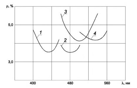
1 — образцы из кварцевого стекла марки КВ [ $\lambda(\rho_{\min})$  = 435 нм,  $n_2h_2$  = 218 нм]; 2 — образцы из кварцевого стекла марки КВ [ $\lambda(\rho_{\min})$  = 480 нм,  $n_2h_2$  = 240 нм]; 3 — образцы из стекла марки К8 [3- $\lambda(\rho_{\min})$  = 500 нм,  $n_2h_2$  = 250 нм]; 4 — образцы из стекла марки К8 [ $\lambda(\rho_{\min})$  = 530 нм,  $n_2h_2$  = 265 нм]
