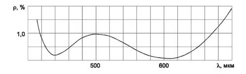
Рисунок Е.5 — Кривая спектрального коэффициента отражения  $\rho(\lambda)$  двухслойного ахроматического покрытия 44Р.43Р на стекле марки ТФ3
