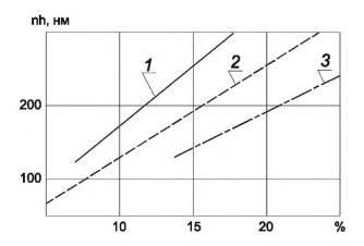
1 — частота вращения детали составляет 1000 мин<sup>-1</sup>; 2 — частота вращения детали составляет 2500 мин<sup>-1</sup>; 3 — частота вращения детали составляет 4800 мин<sup>-1</sup>
