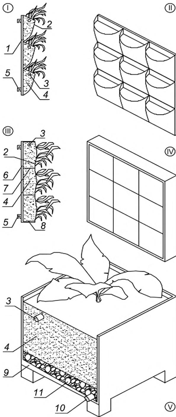
I — мягкие текстильные контейнеры, разрез; II — мягкие текстильные контейнеры, схема модульной сборки; III — вертикальный контейнер, разрез; IV — вертикальный контейнер, модульная сборка; V — горизонтальный контейнер; 1 — панель; 2 — нетканое полотно; 3 — трубка полива; 4 — субстрат; 5 — кронштейн; 6 — вертикальный контейнер; 7 — водопроницаемая перегородка; 8 — дренажное отверстие; 9 — горизонтальный контейнер; 10 — дренажная трубка; 11 — дренирующий слой
