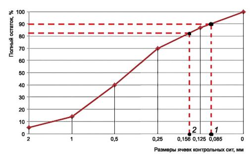
1 — эффективный размер частиц песка, которому соответствует номинальный размер ячеек сита, полный остаток на котором равен 90 %; 2 — эффективный размер частиц смеси, которому соответствует номинальный размер ячеек сита, полный остаток на котором рассчитан по формуле (Б.1), при содержании песка в смеси 60 %
