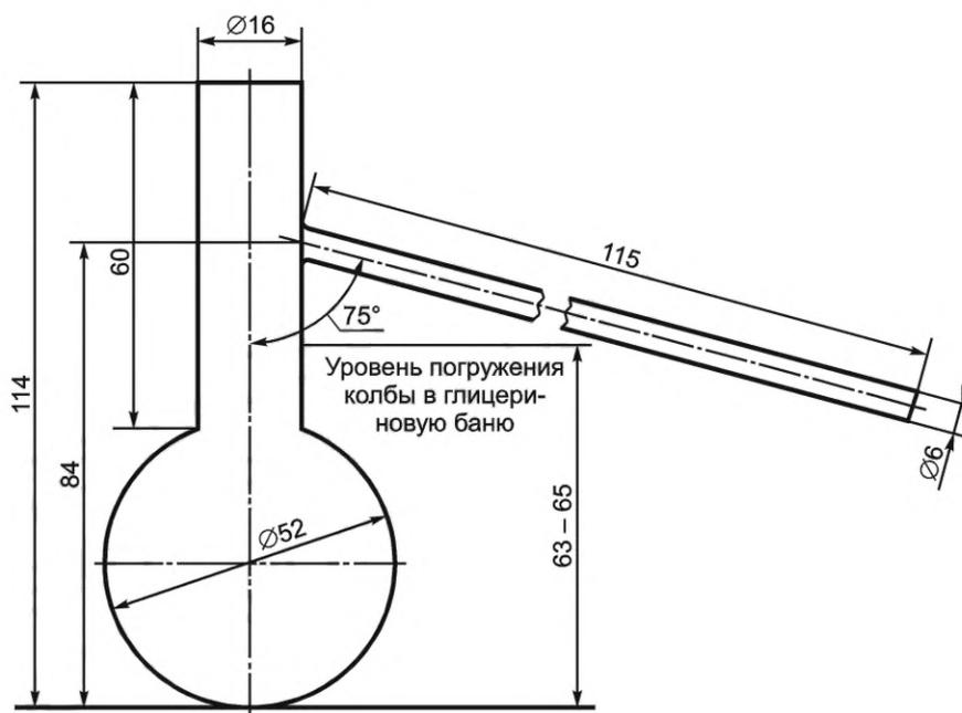
Рисунок 1 — Колба для отгонки четыреххлористого углерода
