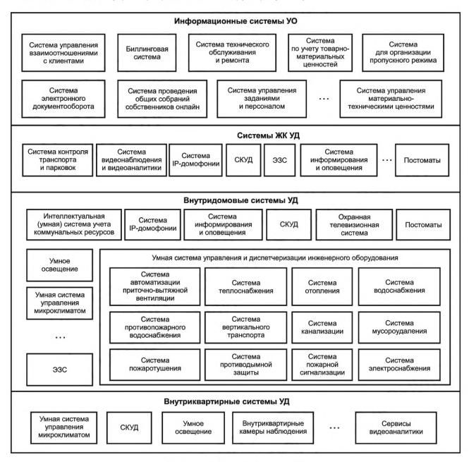
Рисунок 1 — Типовая структура УД
