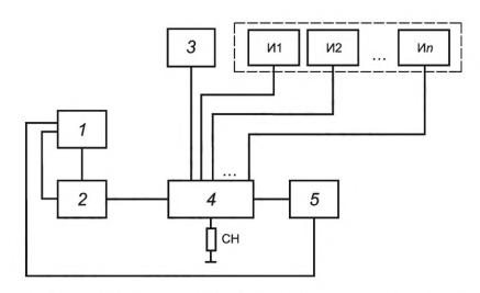
1 — скалярный анализатор цепей; 2 — датчик КСВН; 3 — источник питания; 4 — ИУ; 5 — детекторная головка; И1, И2... Ил — источники управления; СН — согласованная нагрузка
