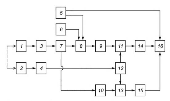
1 и 2 — СВЧ-генераторы; 3 и 4 — СВЧ-усилители (в случае необходимости); 5 — импульсный(е) источник(и) управления; 6 — источник питания; 7 — делитель мощности; 8 — ИУ; 9 и 10 — аттенюаторы; 11 и 13 — смесители СВЧ; 12 — делитель мощности; 14 и 15 — фильтры нижних частот; 16 — осциллограф
