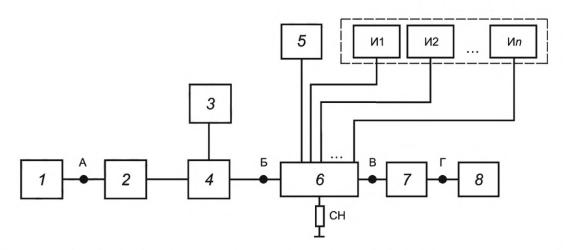
1 — СВЧ-генератор; 2 — изолятор; 3 — измеритель мощности; 4 — направленный ответвитель; 5 — источник питания; 6 — ИУ; 7 — аттенюатор; 8 — анализатор спектра; И1, И2... Ил — источники управления; СН — согласованная нагрузка
