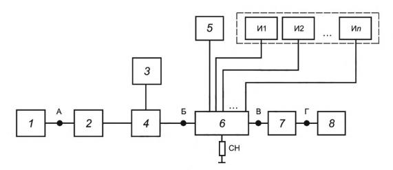
1 — СВЧ-генератор; 2 — изолятор; 3 — измеритель мощности; 4 — направленный ответвитель; 5 — источник питания; 6 — ИУ; 7 — аттенюатор; 8 — анализатор спектра; И1, И2... Иn — источники управления
