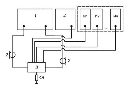
1 — ВАЦ; 2 — СВЧ кабельные сборки; 3 — ИУ; 4 — источник питания; И1, И2... Иn — источники управления; СН — согласованная нагрузка
