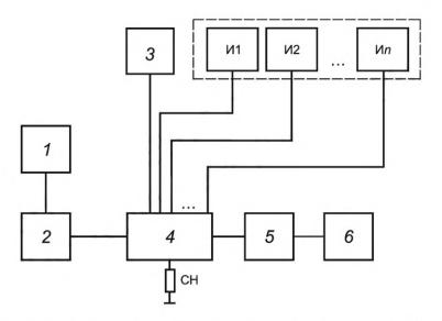
1 — СВЧ-генератор; 2 — СВЧ-предусилитель; 3 — источник питания; 4 — ИУ; 5 — аттенюатор; 6 — анализатор спектра; И1, И2... Иn — источники управления; СН — согласованная нагрузка
