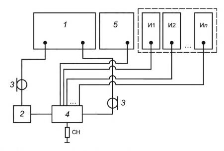
1 — ВАЦ; 2 — СВЧ-предусилитель; 3 — СВЧ кабельные сборки; 4 — ИУ; 5 — источник питания; И1, И2... Иn — источники управления; СН — согласованная нагрузка
