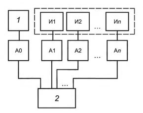
1 — источник питания; 2 — ИУ, И1, И2... И*п* — источники управления; А0, А1, А2 ... А*п* — измерители постоянного тока Рисунок 16 — Схема измерения тока потребления
