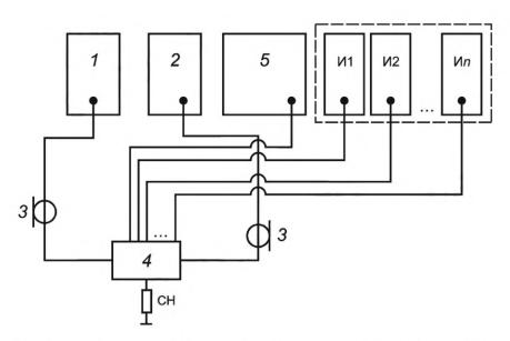
1 — СВЧ-генератор; 2 — СИ выходных параметров; 3 — СВЧ кабельные сборки; 4 — ИУ; 5 — источник питания; И1, И2... Ил — источники управления; СН — согласованная нагрузка
