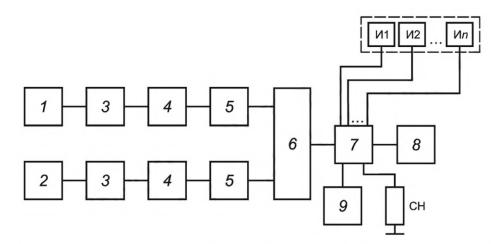
1 — СВЧ-генератор 1; 2 — СВЧ-генератор 2; 3 — фильтрующие цепи (при необходимости); 4 — усилители (при необходимости);
