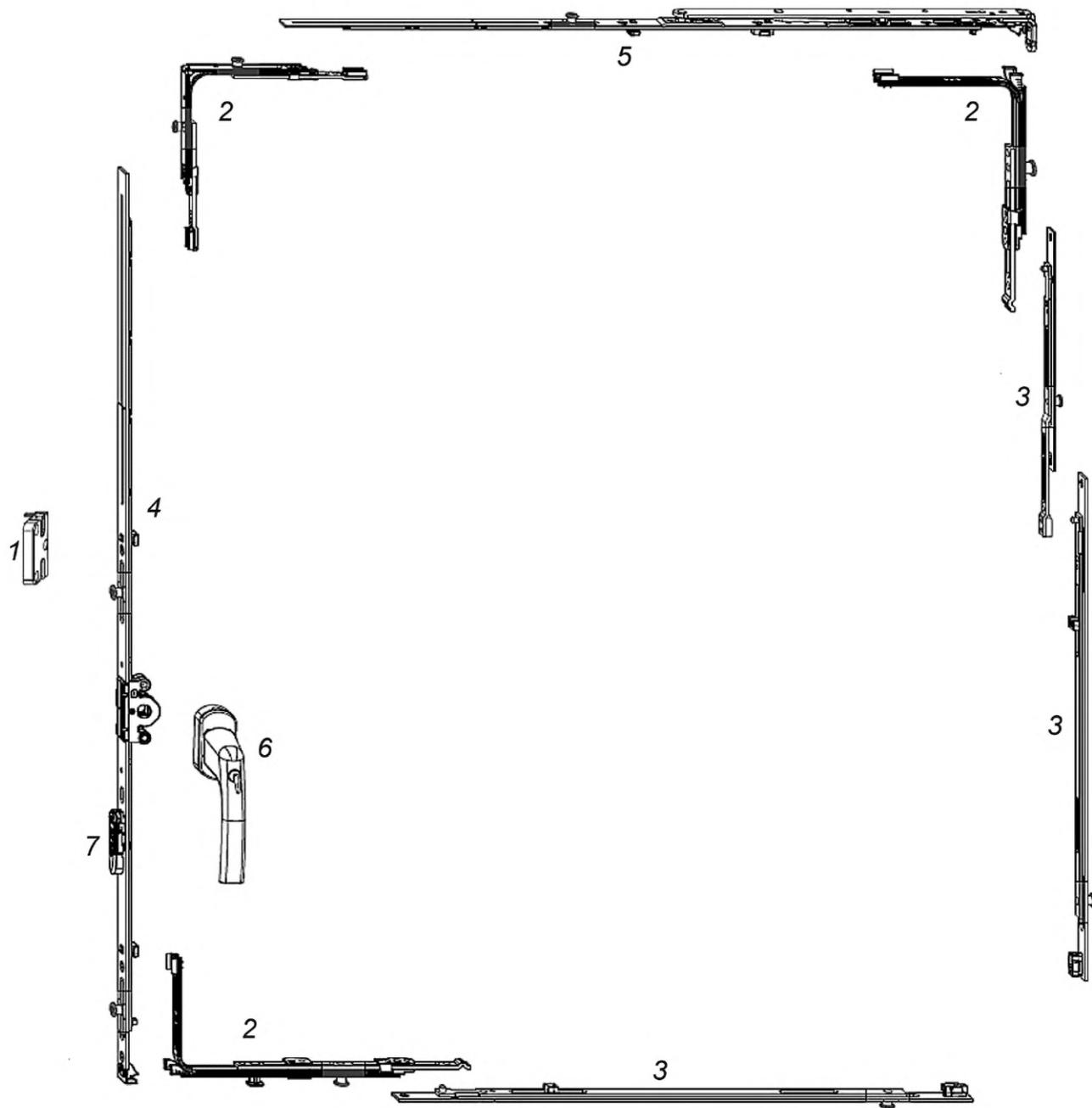
1 — запорная (ответная) планка; 2 — угловая передача; 3 — средний запор (удлинитель); 4 — привод (основной механизм);
