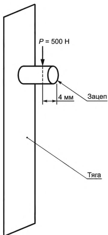
Рисунок Ж.4 — Схема приложения статической нагрузки при испытании прочности крепления зацепа
