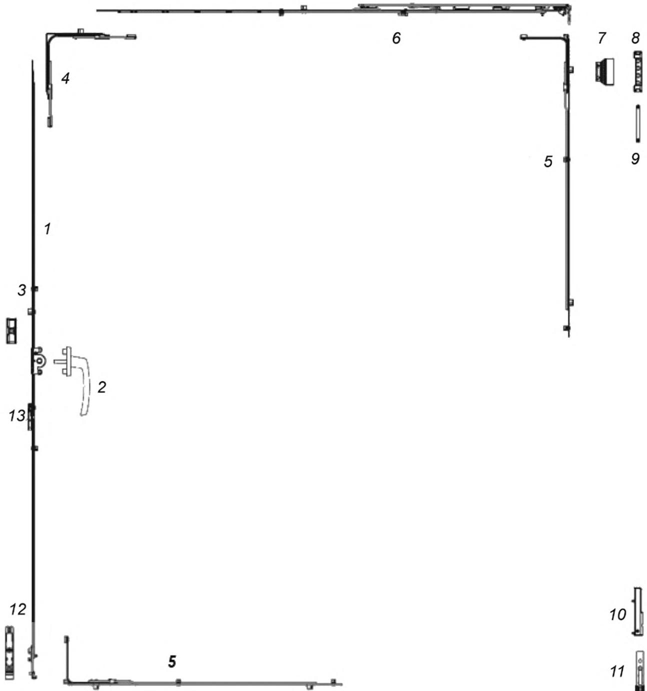
1 — привод (основной механизм); 2 — ручка; 3 — запорная (ответная) планка; 4 — угловая передача; 5 — угловой удлинитель (средний запор); 6 — ножницы; 7 — створочная часть верхней петли; 8 — рамная часть верхней петли; 9 — ось верхней петли; 10 — створочная часть нижней петли; 11 — рамная часть нижней петли; 12 — запорно-откидная планка; 13 — блокиратор ошибочного действия с микролифтом
