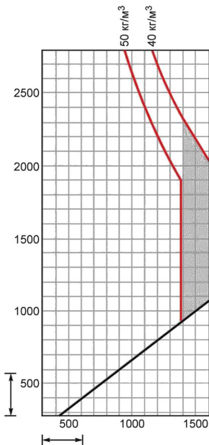
**Примечание** — Данные на диаграмме применения устройства обозначают массу стеклопакета в  $\text{кг}/\text{м}^2$ . Масса  $1\text{ м}^2$  стекла при толщине 1,0 мм составляет 2,5 кг.
