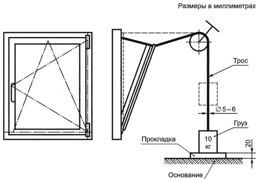
Примечание — Падение груза прекращают на расстоянии 20 мм от основания (например, с помощью прокладки). Длину троса определяют из условия касания грузом основания при максимальном раскрытии ножниц.
