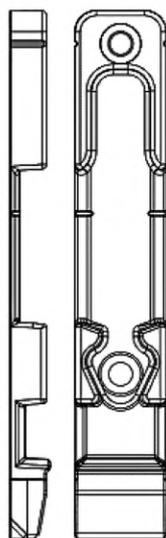
Рисунок В.4 — Запорно-откидная планка
