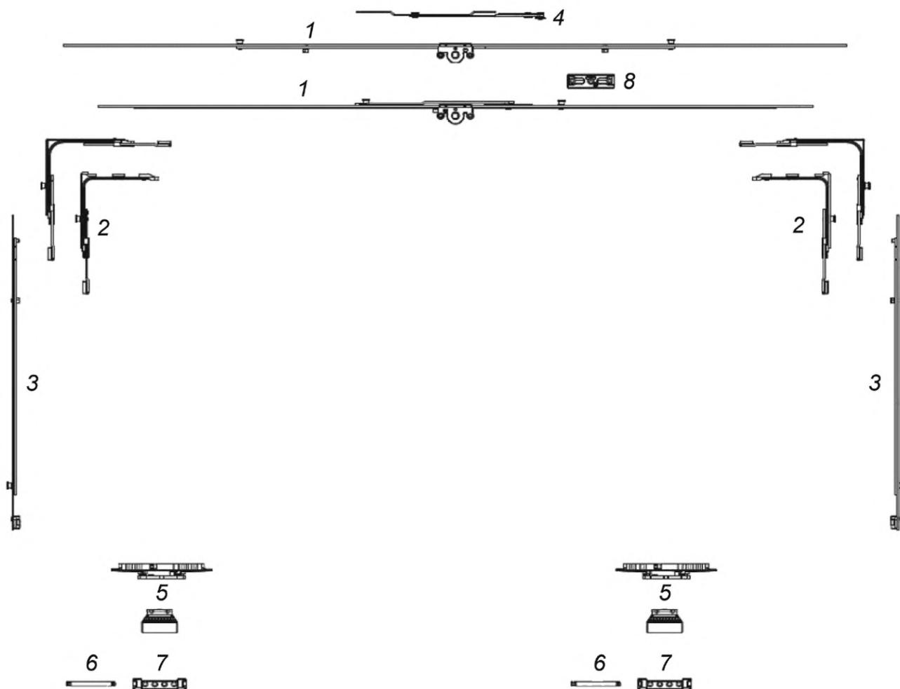
1 — привод (основной механизм); 2 — угловая передача; 3 — средний запор; 4 — откидные ножницы (фрамужный механизм);
