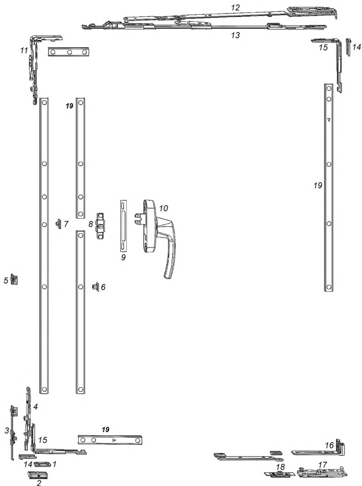
1 — подпятник; 2 — запорно-откидная планка; 3 — защита от вывешивания; 4 — откидной ригель; 5 — запорная (ответная) планка; 6 — цапфа (зацеп); 7, 8 — приемник под ручку; 9 — опора под ручку; 10 — ручка-привод; 11 — угловая передача с блокиратором откидывания; 12, 13 — ножницы; 14, 15 — угловая передача (дополнительный прижим); 16 — створочная часть нижней петли; 17 — рамная часть нижней петли; 18 — ограничитель поворота; 19 — тяга
