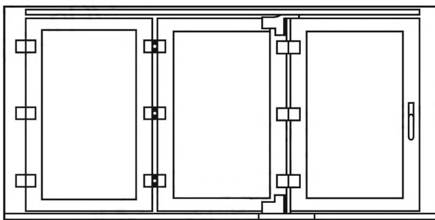
Рисунок Б.5 — Схема сдвижного (раздвижного) складывающегося открывания
