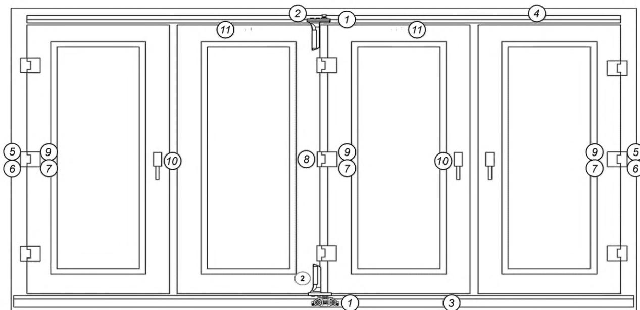
1 — ходовой механизм; 2 — навесы; 3 — ходовая шина; 4 — направляющая шина; 5 — опора петли на раме; 6 — подложка под опору петли на раме; 7 — крепление петли; 8 — опора петли на створке; 9 — петля; 10 — плоская/стандартная ручка; 11 — фиксатор створки/стопор створки
