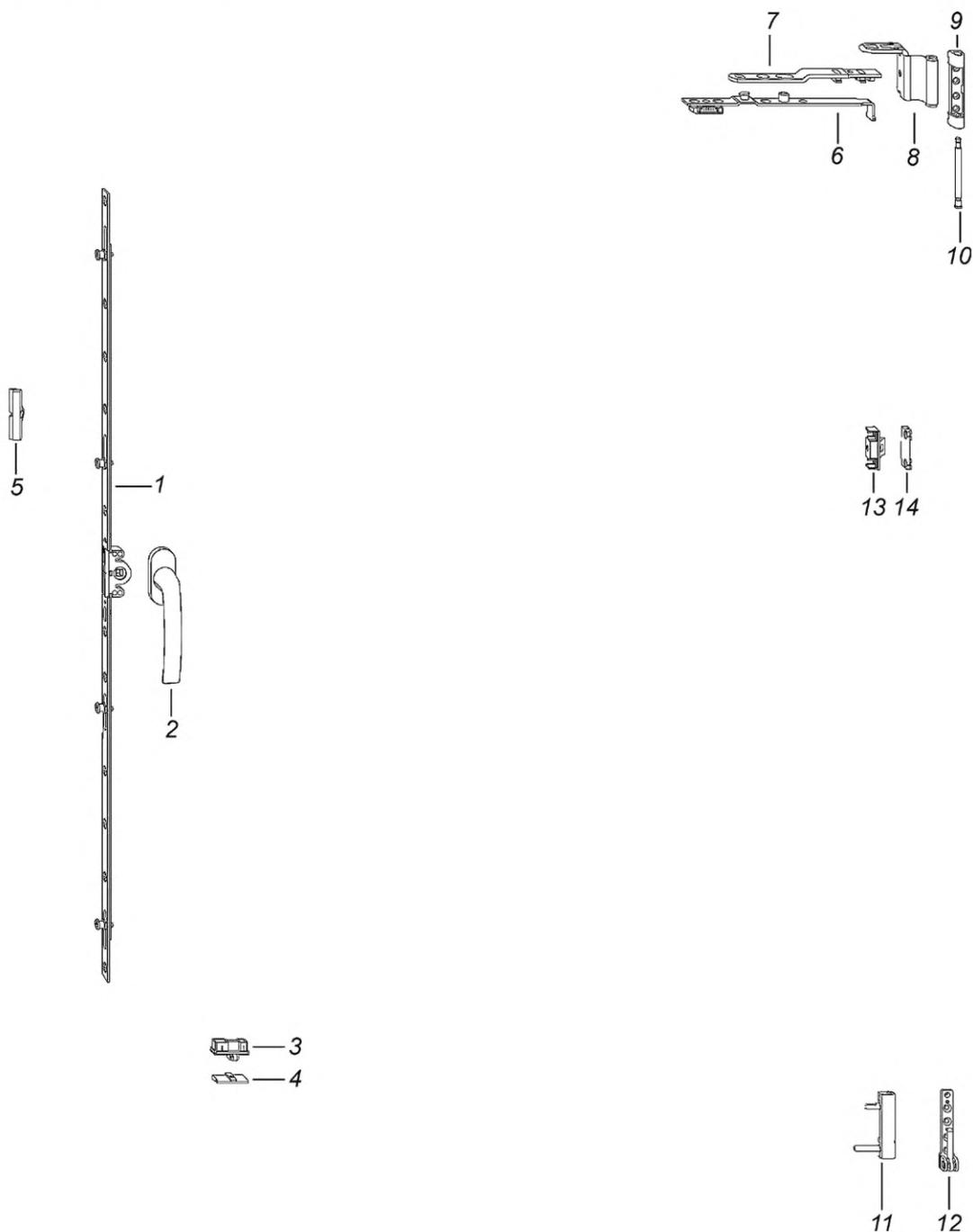
1 — привод (основной механизм); 2 — ручка; 3, 4 — приподниматель (микролифт); 5 — запорная (ответная) планка; 6, 7 — поворотные ножницы; 8 — створочная часть верхней петли; 9 — рамная часть верхней петли; 10 — ось верхней петли; 11 — створочная часть нижней петли; 12 — рамная часть нижней петли; 13, 14 — дополнительный прижим
