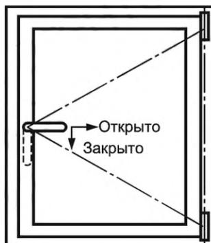
Рисунок Б.1 — Схема поворотного открывания
