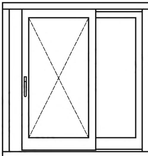
Рисунок Б.5.2 — Схема сдвижного открывания
