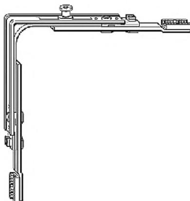
Рисунок В.1 — Угловая передача
