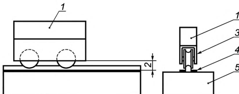
1 — нагрузка; 2 — прогиб; 3 — роллер; 4 — направляющая (рельс); 5 — часть испытательного стенда
