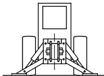
Рисунок 2 — Экскаватор-погрузчик с центральным поворотом перемещением стрелы обратной лопаты
