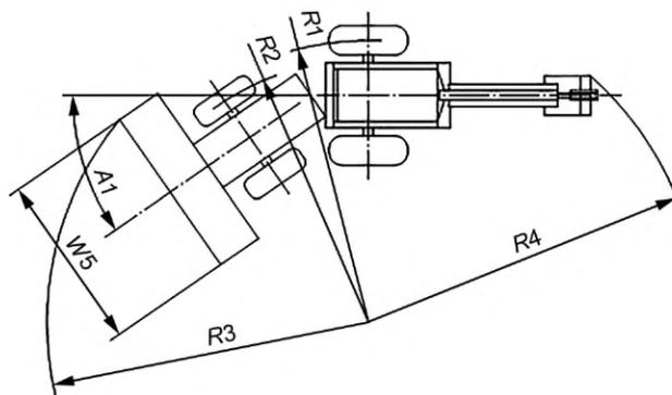
Рисунок 14 — Размерные характеристики при маневрировании (с шарнирно-сочлененной рамой)
