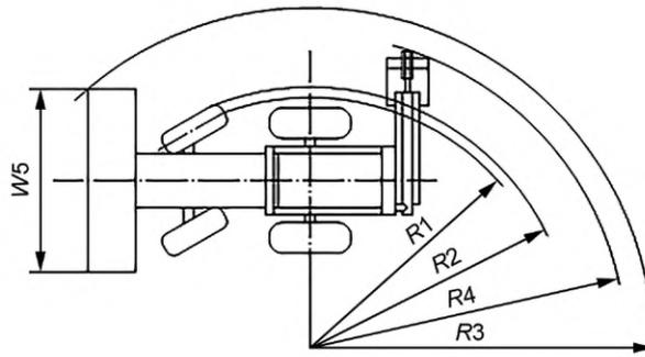
Рисунок 13 — Размерные характеристики при маневрировании (с жесткой рамой)
