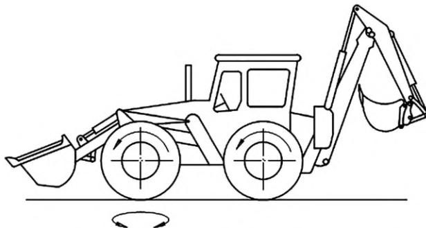
Рисунок 4 — С жесткой рамой, управляемыми передними/всеми колесами и с приводом на все колеса
