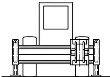
Рисунок 1 — Экскаватор-погрузчик с боковым перемещением стрелы обратной лопаты
