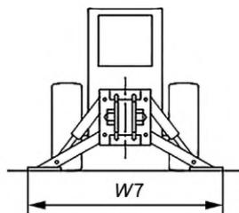
Рисунок 11 — Обратная лопата с центральным поворотом стрелы
