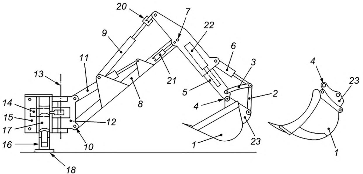
1 — ковш; 2 — соединение ковша; 3 — направляющий рычаг; 4 — ось шарнира ковша; 5 — рукоять (выдвижная); 6 — цилиндр ковша; 7 — ось рукояти; 8 — стрела; 9 — цилиндр рычага; 10 — ось шарнира стрелы; 11 — цилиндр стрелы; 12—19 — см. рисунки 15 и 16; 20 — соединительное звено; 21 — цилиндр бокового отклонения; 22 — цилиндр выдвижения рукояти; 23 — кронштейн рабочего органа
