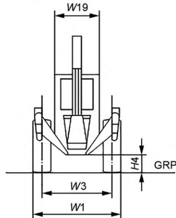
Рисунок 7 б) — Обратная лопата с центральным поворотом стрелы
