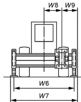
Рисунок 12 — Обратная лопата с боковым перемещением стрелы
