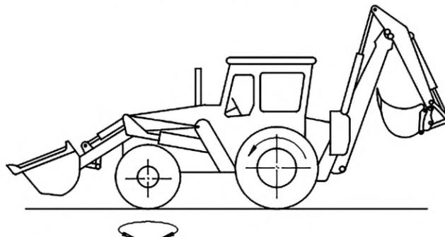
Рисунок 3 — С жесткой рамой, управляемыми передними колесами и с приводом на задние колеса
