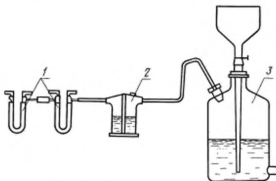
1 — трубки ТХ-У; 2 — склянка для промывания газов;
