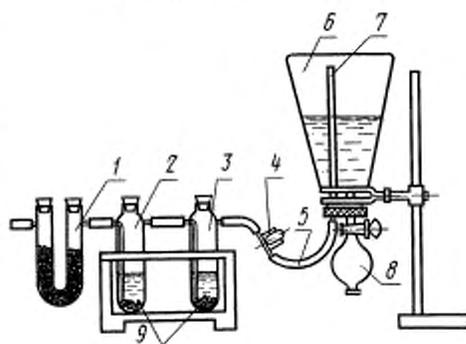
1 — трубка ТХ-У; 2, 3 — склянки для промывания газов; 4 — винтовой зажим; 5 — резиновая трубка; 6 — коническая колба; 7 — стеклянная трубка; 8 — каплевая воронка; 9 — фильтры
