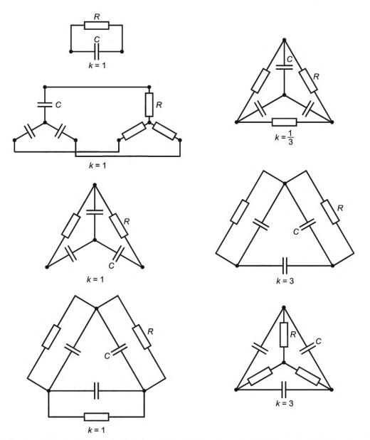
Рисунок В.1 — Значения k в зависимости от способа соединения резисторов с единичными конденсаторами
