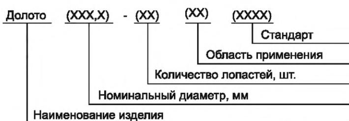
Рисунок 1 — Структура условного обозначения долот
