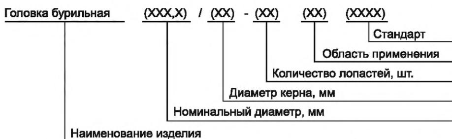
Рисунок 2 — Структура условного обозначения бурильных головок
