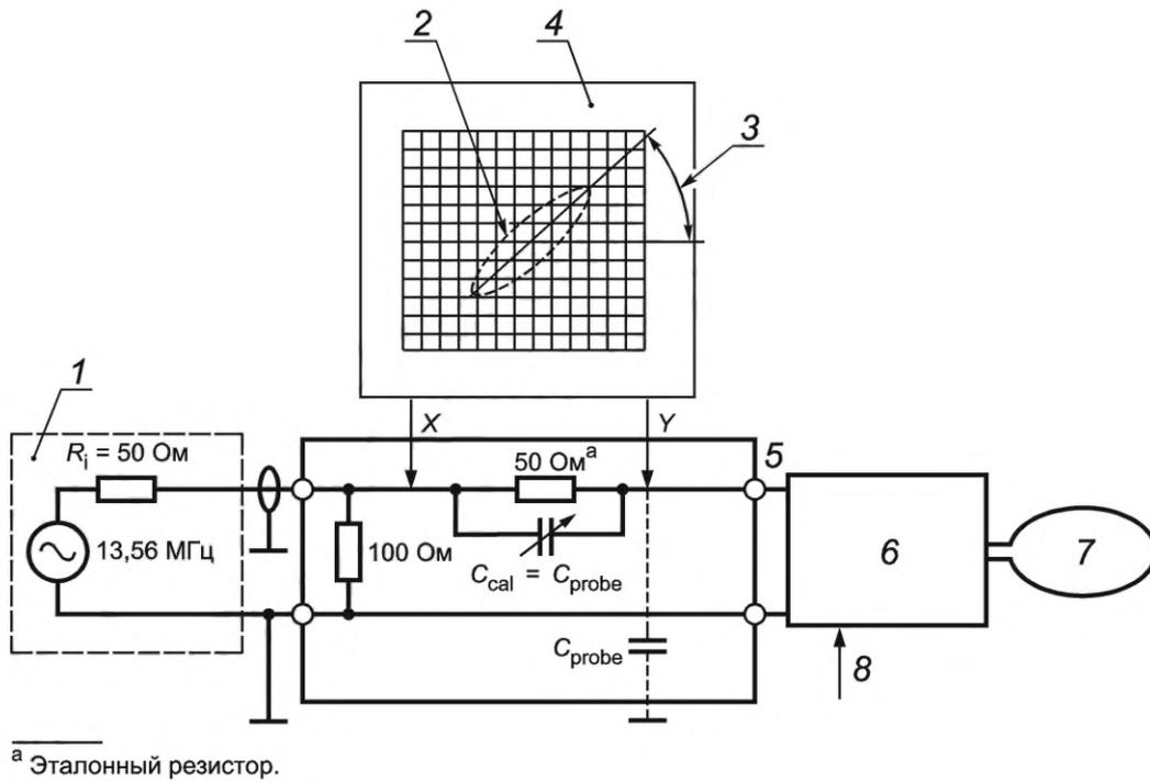
1 — генератор сигналов; 2 — замкнутая фигура:  $\Phi=0$ ; 3 — угол, соответствующий 50 Ом; 4 — осциллограф; 5 — выход;
