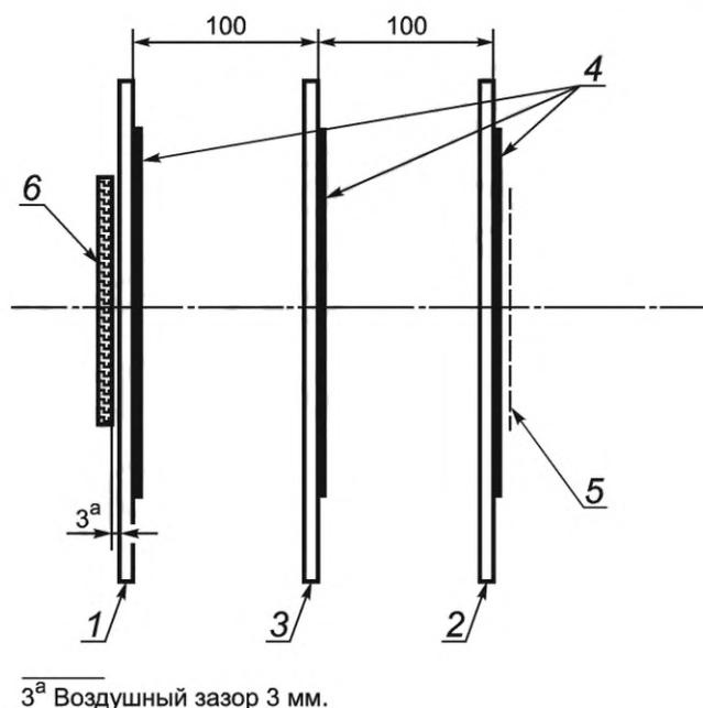
1 — катушка считывания *a*; 2 — катушка считывания *b*; 3 — антенна терминального оборудования VCD; 4 — активные проводники;
