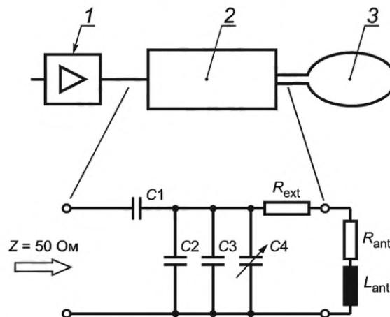
1 — генератор мощности, 50 Ом; 2 — сеть, согласованная по импедансу; 3 — антенная катушка;  $Z$  — входной импеданс;  $R_{ext}$  — внешнее сопротивление;  $R_{ant}$  — сопротивление антенны;  $L_{ant}$  — индуктивность антенны;  $C1, C2, C3, C4$  — конденсаторы
