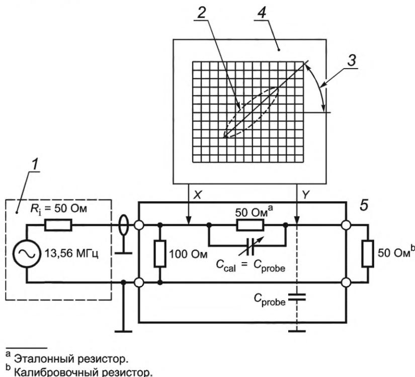
1 — генератор сигналов; 2 — замкнутая фигура:  $\Phi=0$ ; 3 — угол, соответствующий  $50 \text{ Ом}$ ; 4 — осциллограф; 5 — выход;
