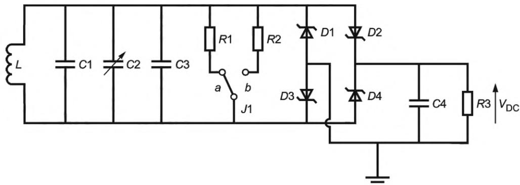
$L$  — антенная катушка;  $C1$ ,  $C2$ ,  $C3$ ,  $C4$  — конденсаторы;  $D1$ ,  $D2$ ,  $D3$ ,  $D4$  — диоды;  $R1$ ,  $R2$ ,  $R3$  — резисторы;  $J1$  — конфигурация установки переключки;  $V_{DC}$  — выходное напряжение
