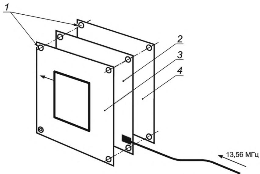
1 — соединения; 2 — антенна испытательного терминального оборудования VCD; 3 — катушка считывания *a*;
