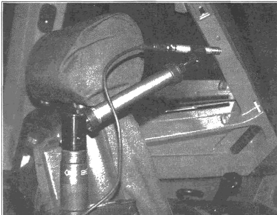
Рисунок 36 — Пример расположения микрофона рядом с креслом пилота
