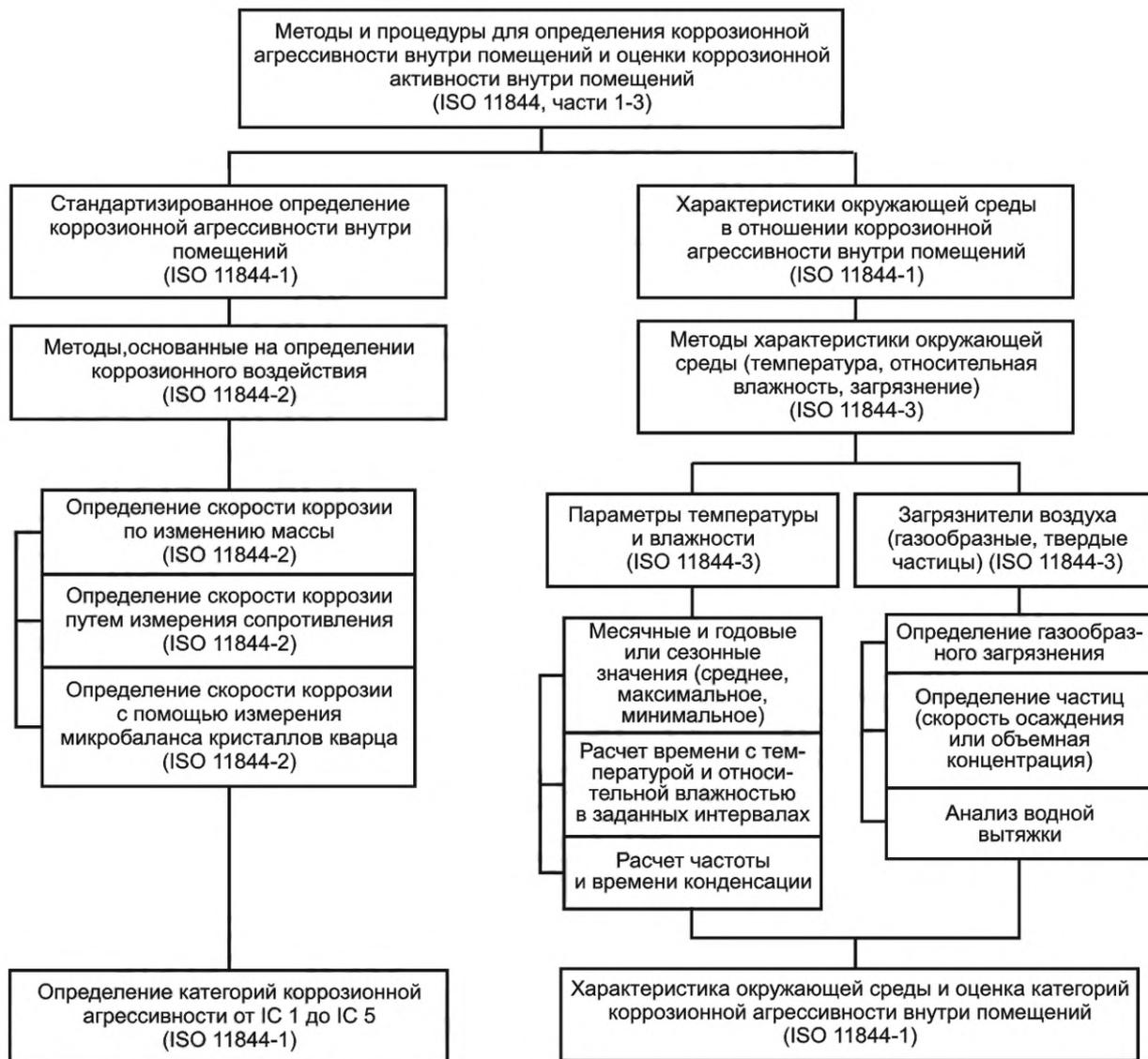
Рисунок 1 — Схема классификации слабоагрессивных сред помещений
