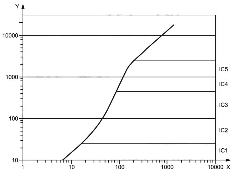
X — прирост массы после 30 дней воздействия, мг·м<sup>-2</sup>; Y — прирост массы после одного года воздействия, мг·м<sup>-2</sup>
