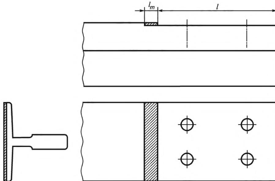
Примечание — Переход между механически обработанной поверхностью под стыковую планку и необработанной задней поверхностью подошвы находится в заштрихованной области.
