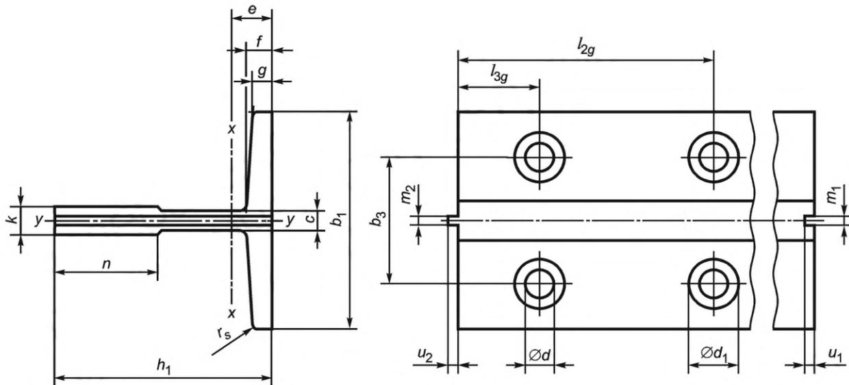
Рисунок 2 — Холоднотянутая направляющая со скошенной кромкой подошвы
