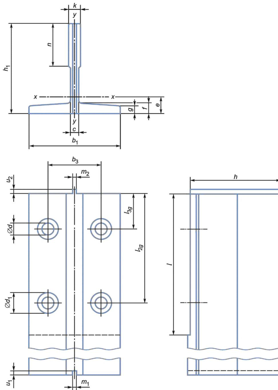
Рисунок А.3 — Направляющая, обработанная механическим способом
