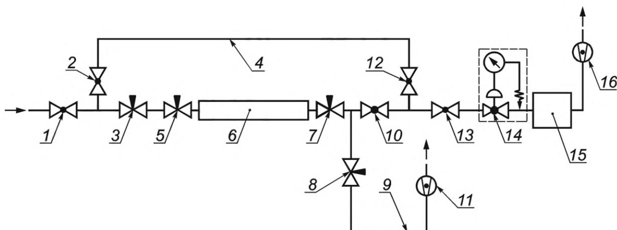
1, 2, 10, 12, 13 — отсекающие шаровые краны; 3 — вентиль; 4 — основная пробоотборная линия;
