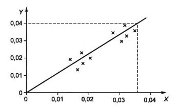
ось X — влагосодержание  $\psi$ , м $^3$ /м $^3$ ; ось Y — In  $(\lambda \lambda_{tr})$ ; коэффициент преобразования влажности  $f_w=$  In  $(\lambda \lambda_{tr})/\psi$
