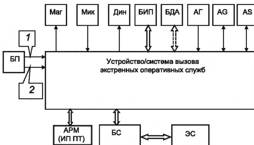
Маг — магнитола АТС; Мик — микрофон; Дин — динамик; БИП — блок интерфейса пользователя; БДА — блок датчика аварии; АГ — антенна ГЛОНАСС; АG — антенна GSM/UMTS; AS — антенна спутниковая; БП — блок питания (12/24 В); БС — блок сопряжения; ЭС — эмулятор системы экстренного реагирования при авариях; 1 — кабель питания; 2 — цепь зажигания
