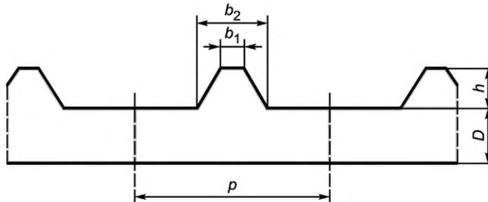
$b_1$  — ширина верхней части трапециевидного профиля;  $b_2$  — ширина нижней части трапециевидного профиля;  $p$  — расстояние между равноудаленными от трапециевидных профилей точками поверхности панели;  $h$  — высота трапециевидного профиля;  $D$  — толщина панели без учета трапециевидного профиля
