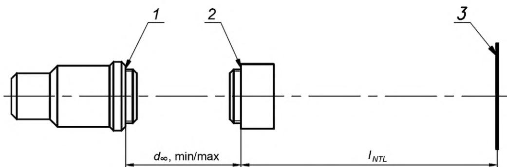
1 — опорная плоскость объектива; 2 — опорная плоскость тубусной линзы; 3 — плоскость изображения
