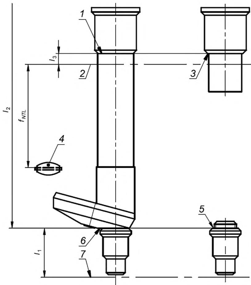
1 — опорная плоскость окулярной трубки; 2 — плоскость изображения; 3 — опорная плоскость окуляра; 4 — тубусная линза;
