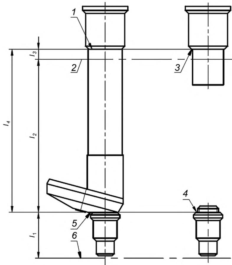
1 — опорная плоскость окулярной трубки; 2 — плоскость изображения; 3 — опорная плоскость окуляра; 4 — опорная плоскость объектива; 5 — опорная плоскость револьверной головки, к которой присоединяют объектив; 6 — плоскость объекта
